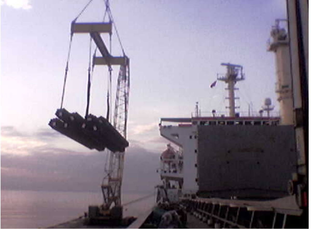
Şekil 5.5 Gemi yükleme için tasarlanan aparat
