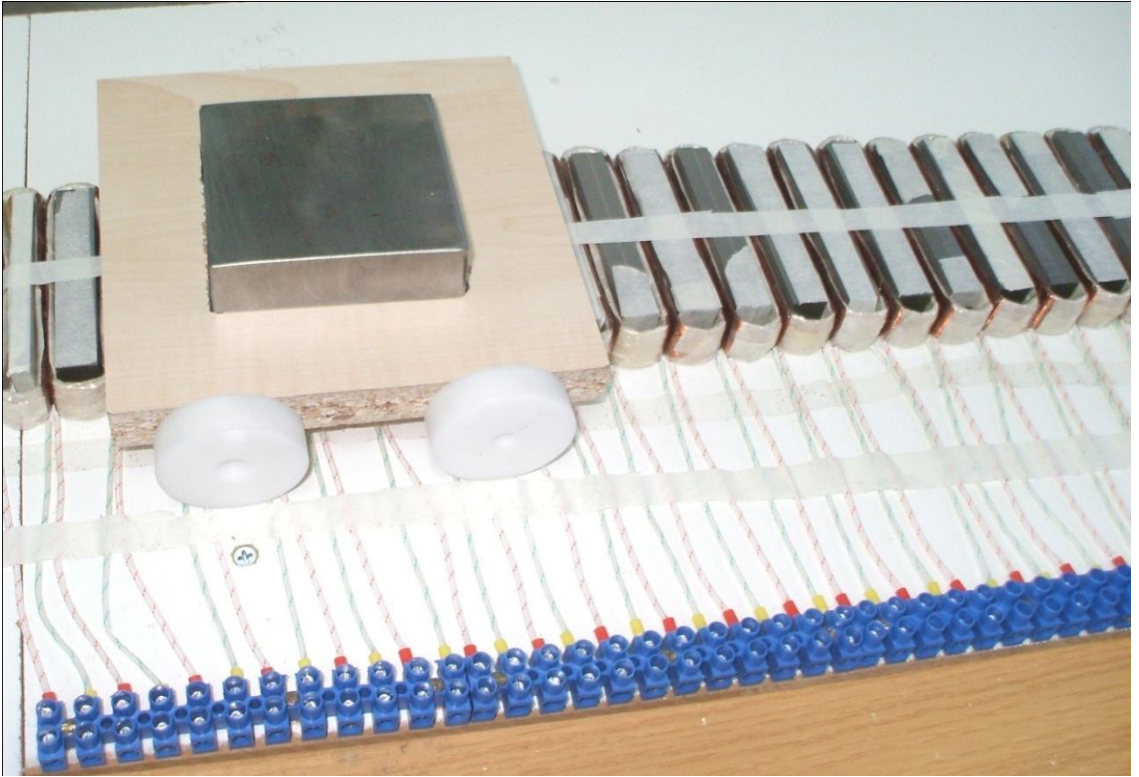
Şekil 3. 17. Primer ve rotor
