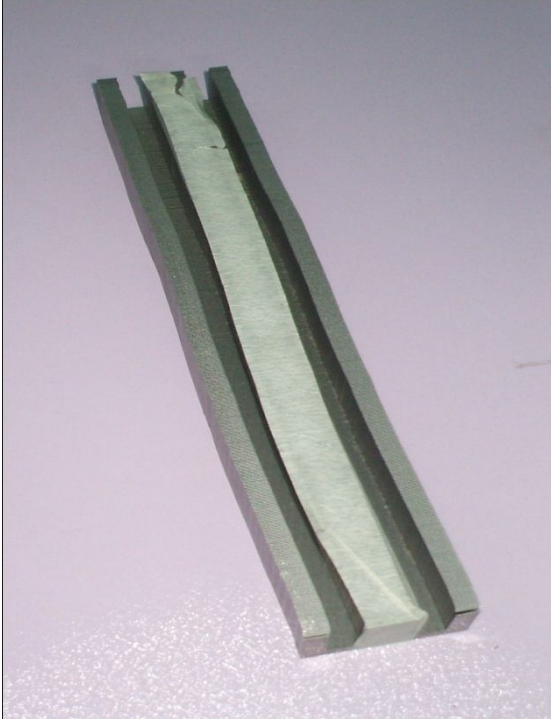
Şekil 3. 24. E tipi trafo sac dizisi
