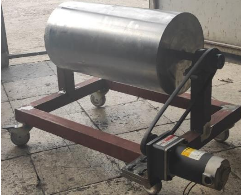
Şekil 2.10 : Kumaş örme makinesini simüle eden tambur.
