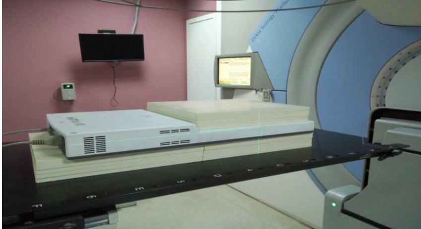
Şekil 3.11. OmniPro MatriXX için ölçüm düzeneği ve ölçümlerin gösterimi
