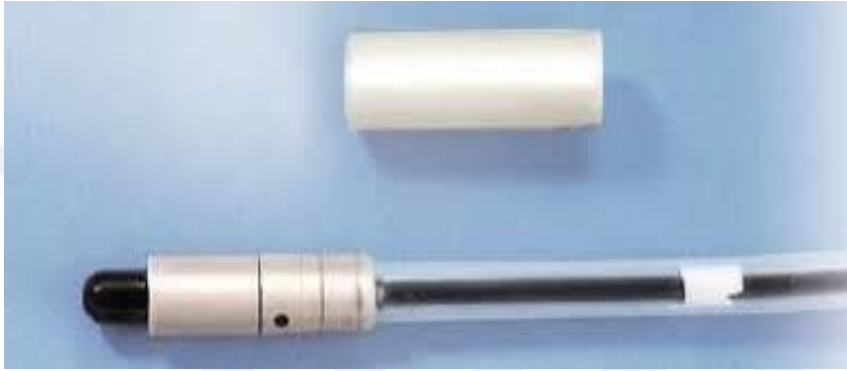
Şekil 3.5. IBA marka CC04 kompakt iyon odası (IBA Dosimetry).
