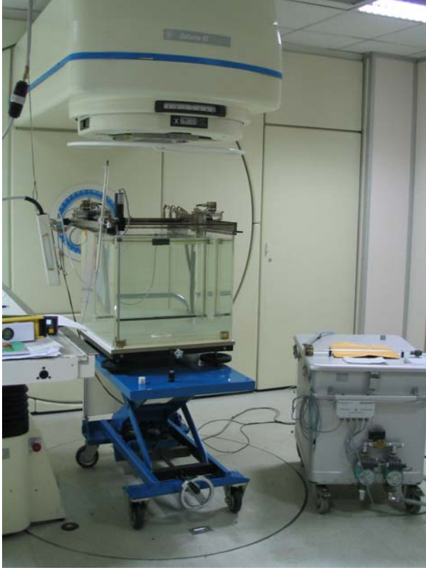
Resim 7.1. Lineer Hızlandırıcı cihazında ölçüm almaya hazır hale getirilmiş su fantomu ve fantomun suyunu taşıyan su tankı.
