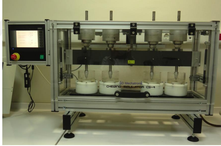
Şekil 3.14: Çiğneme simülatörü (SD Mechatronik GMBH, Westerham, Almanya).
