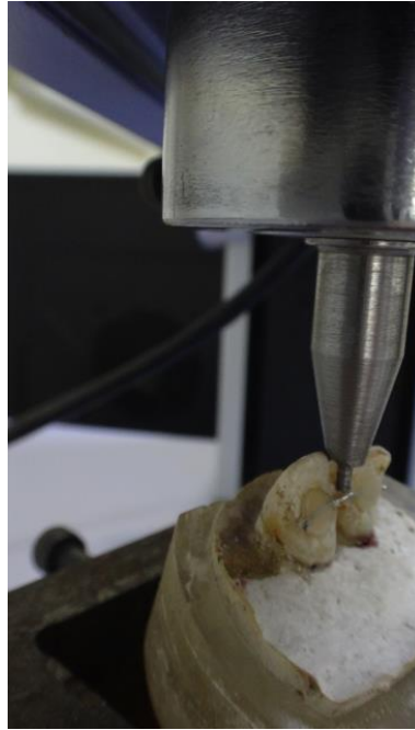
Şekil 3.21: Universal test cihazında (Shimadzu Co., Tokyo, Japonya) bağlanma dayanımı testinin yapılması.
