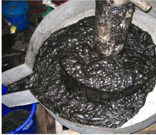
Şekil 3.2. Jameson flotasyon hücresi
