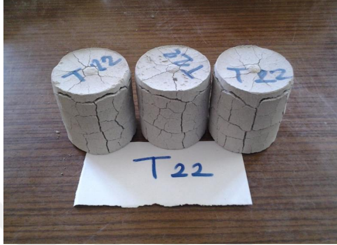
Şekil 3.14 Soma uçucu külü ile hazırlanan tuğlalarda otoklav sonrası görünümü
