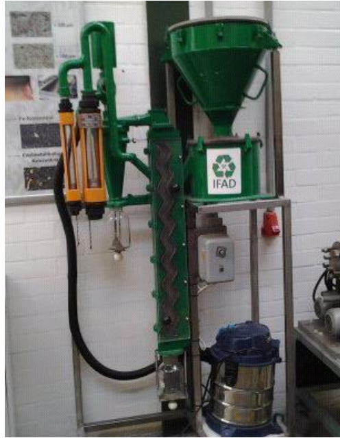
Şekil 3.32 Laboratuvar tipi Zig zag havalı separatör
