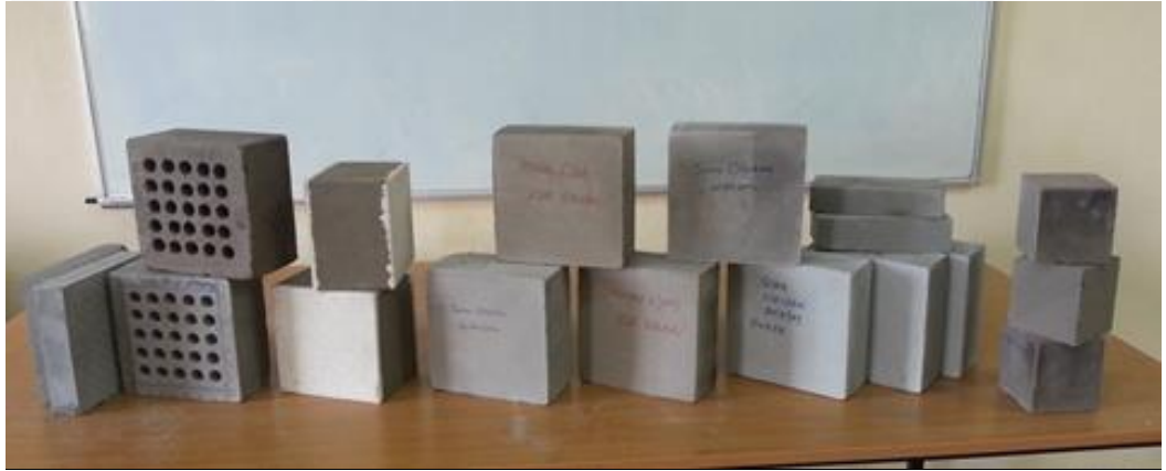
Şekil 3.21 Otoklav ve kür kabinde elde edilmiş tuğla örnekleri
