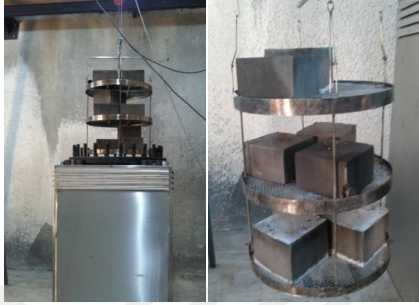
Şekil 3.20 Tuğlaların otoklava yüklenmesi
