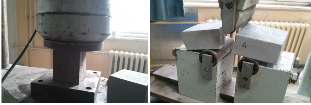
Şekil 3.22 Tek eksenli basınç ve eğilme dayanım testleri
