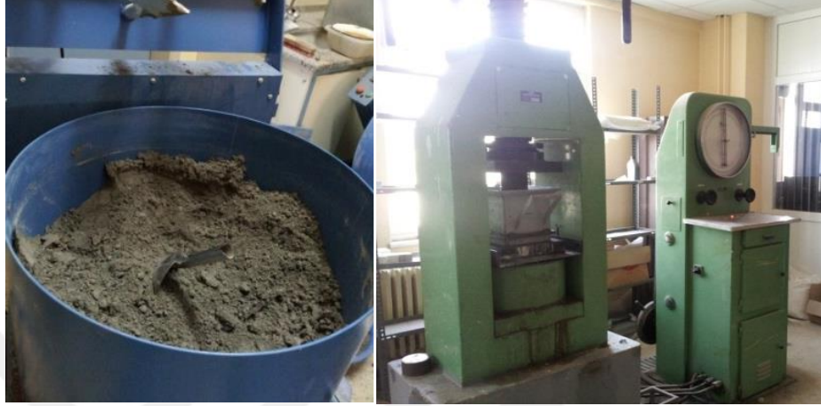
Şekil 3.18 Kül harcının karılması ve kalıba konulan kül harcının preslenmesi
