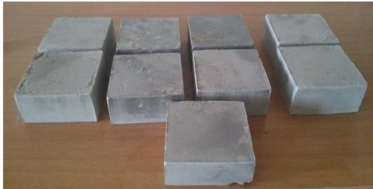
Şekil 3.19 Büyük boy tuğlalar için harç hazırlama ve tuğla şekillendirme
