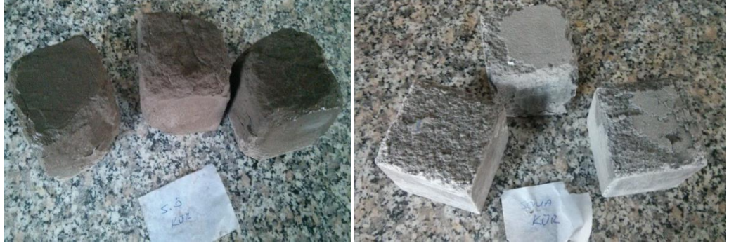
Şekil 3.25 25. donma-çözülme testi Seyitömer ve Soma kür kabini tuğla örneklerinin görüntüsü
