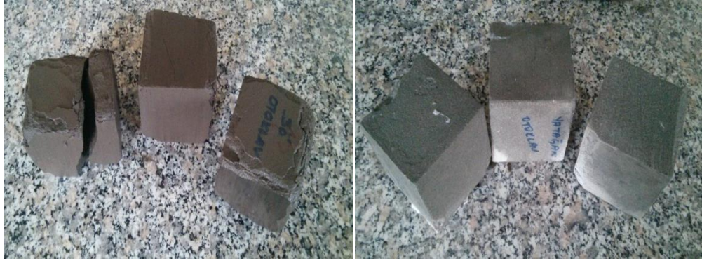
Şekil 3.24 25. donma-çözülme döngüsü sonrasında Seyitömer ve Yatağan otoklav tuğla örneklerinin görüntüsü
