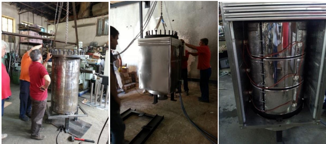
Şekil 3.17 Otoklavın imalat ve yerleşim aşamaları
