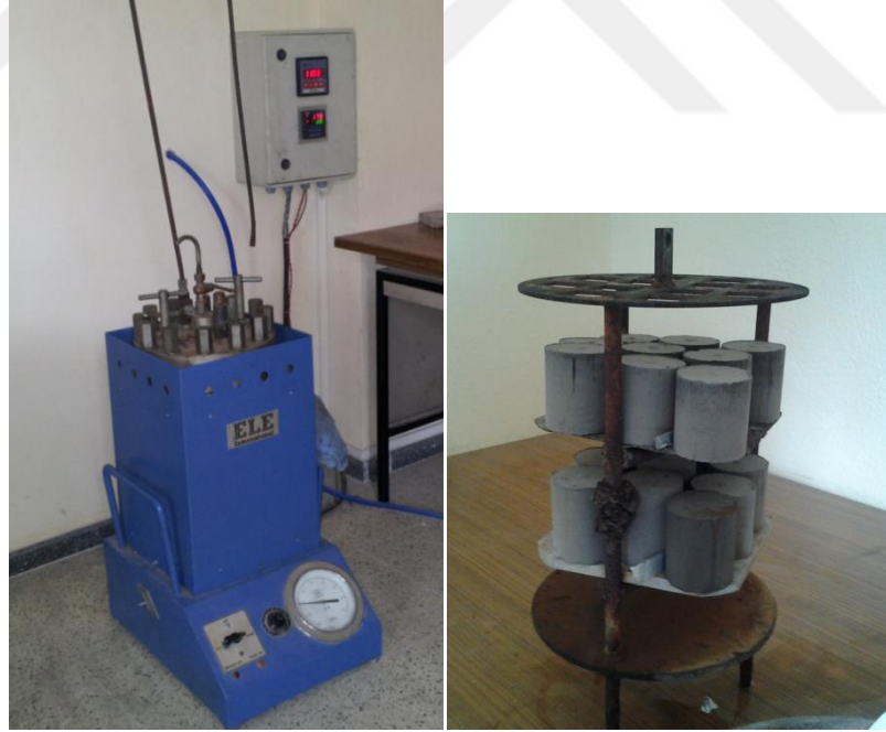
Şekil 3.12 ELE marka buharlı otoklav ve tuğla haznesi
