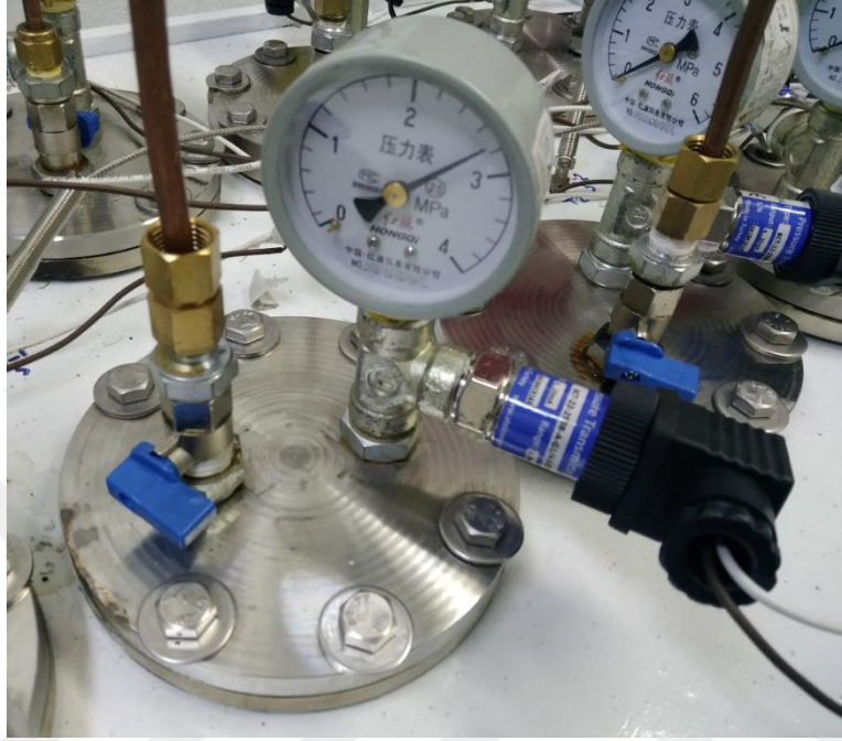
Şekil 4.14 Basınç saati ve basınç transmitteri sabitlenmiş bir reaktör görünümü (Su banyosu içinde)
