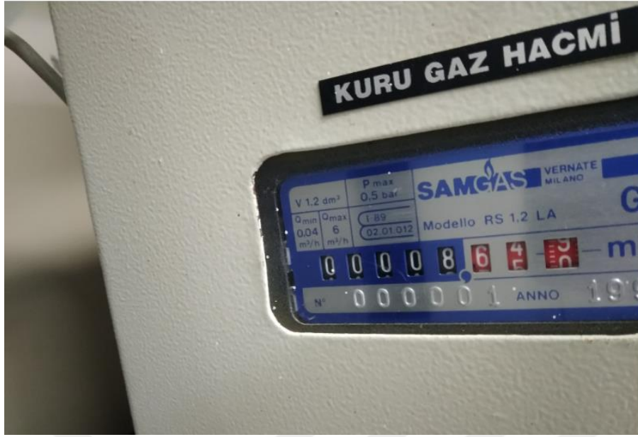
Sekil 4.19 Kuru gaz hacmini belirlemek için kullanılan sayaç.
