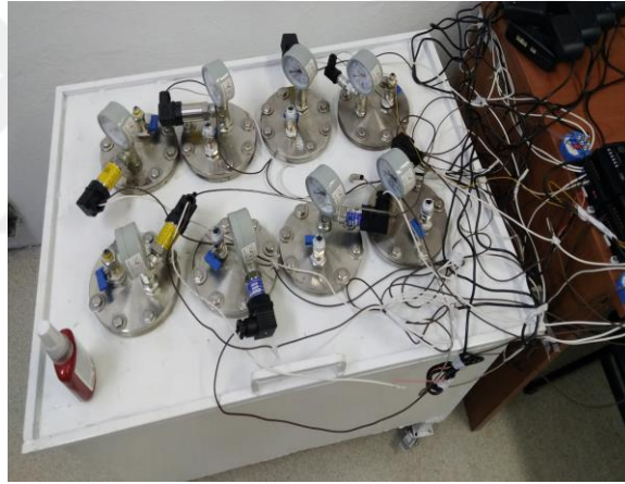
Şekil 4.12 Reaktörlerin Su banyosunda bulunduğu durum, üstten görünüm.
