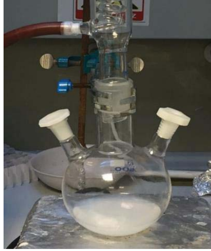
Şekil 3.9. Stöber metodu ile silika nanopartikül sentezi
