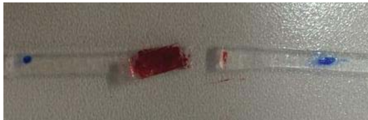
Şekil 4.29. PDMA hidrojinin örtüşme alanı dışında kopması
