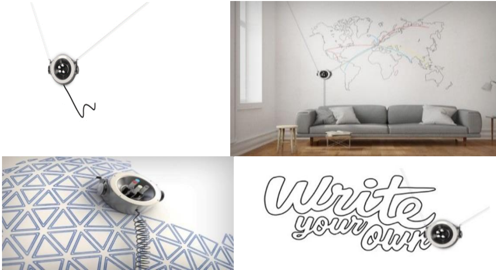
Şekil 30: Scribit, web’den kaynaklı bir içeriğin çizilmesine ve gerçek zamanlı olarak güncellenmesine izin veren bir yazma ve silme robotu.
