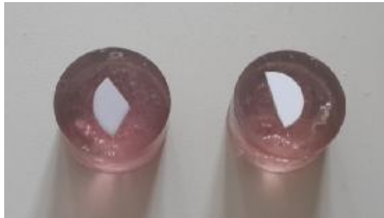
Şekil 4.1. SEM analizi için rezine gömülen örnekler
