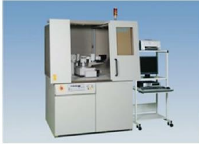
Şekil 7.8. Rigaku D/MAX 2000 marka X-ışınları difraktometresi
