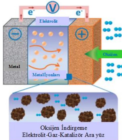
Şekil 2.4. Bir metal hava pil hücreği yapısı ve çalışma prensibine ait şema [31].
