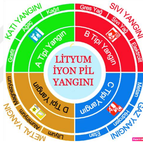
Şekil 1.14. Lityum ion pillerin oluşturduğu yangın tipleri.
