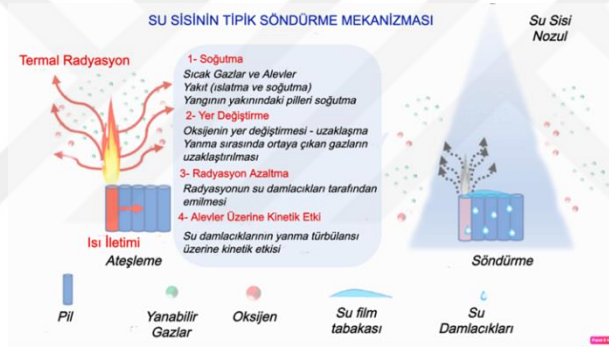
Şekil 1.19. Su sisinin tipik söndürme mekanizması.
