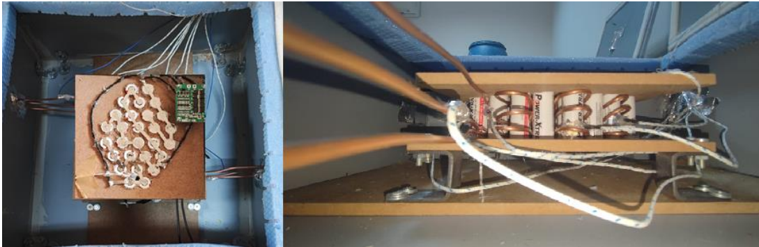
Şekil 3.13. Üç borulu dışbükey dizilime sahip batarya paketi
