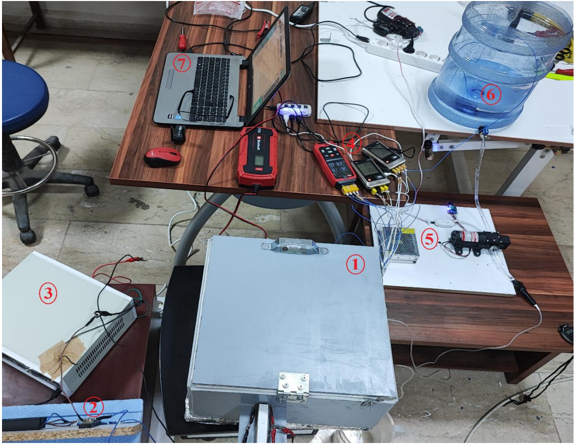
Şekil 3.19. Sıvı soğutma deney düzeneği ve kullanılan ekipmanlar
