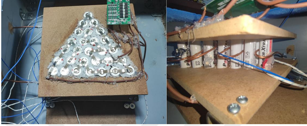
Şekil 3.9. Bir borulu üçgen dizilime sahip batarya paketi
