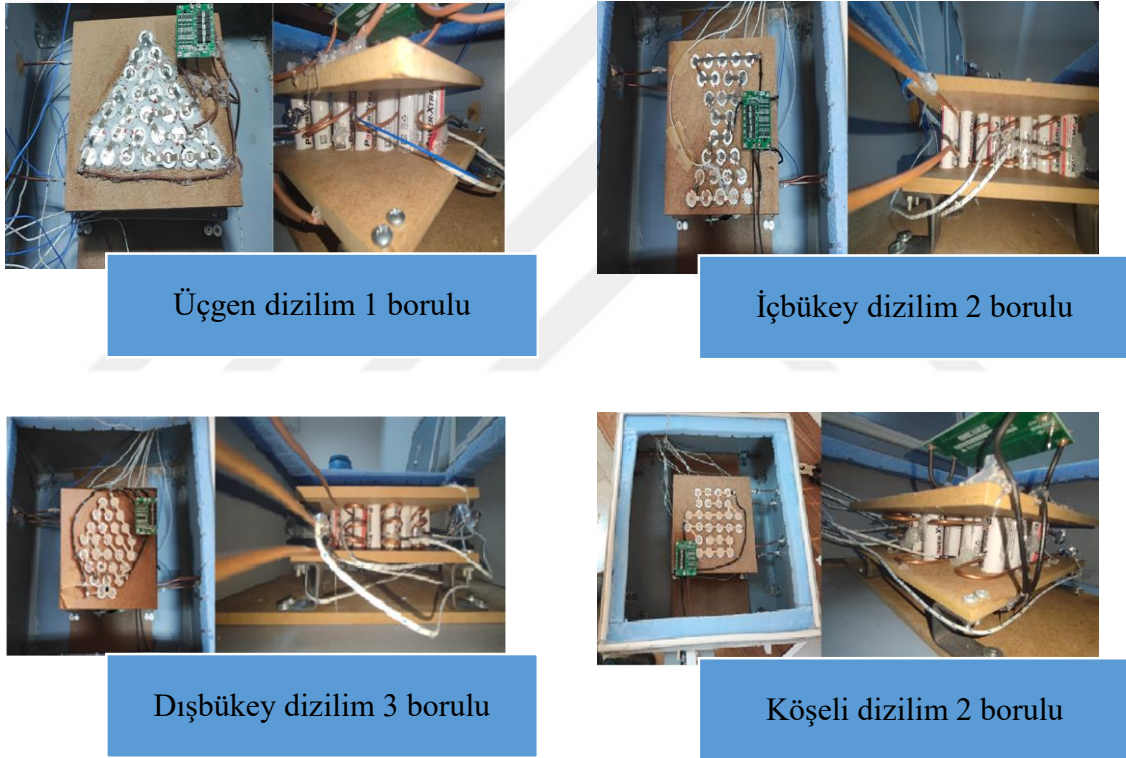
Şekil 3.17. Dizilimlere ait sıvı soğutma deney düzenekleri
