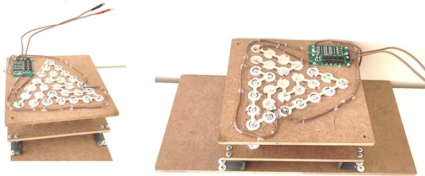
Şekil 3.2. Üçgen dizilime sahip alt plakalı batarya paketi
