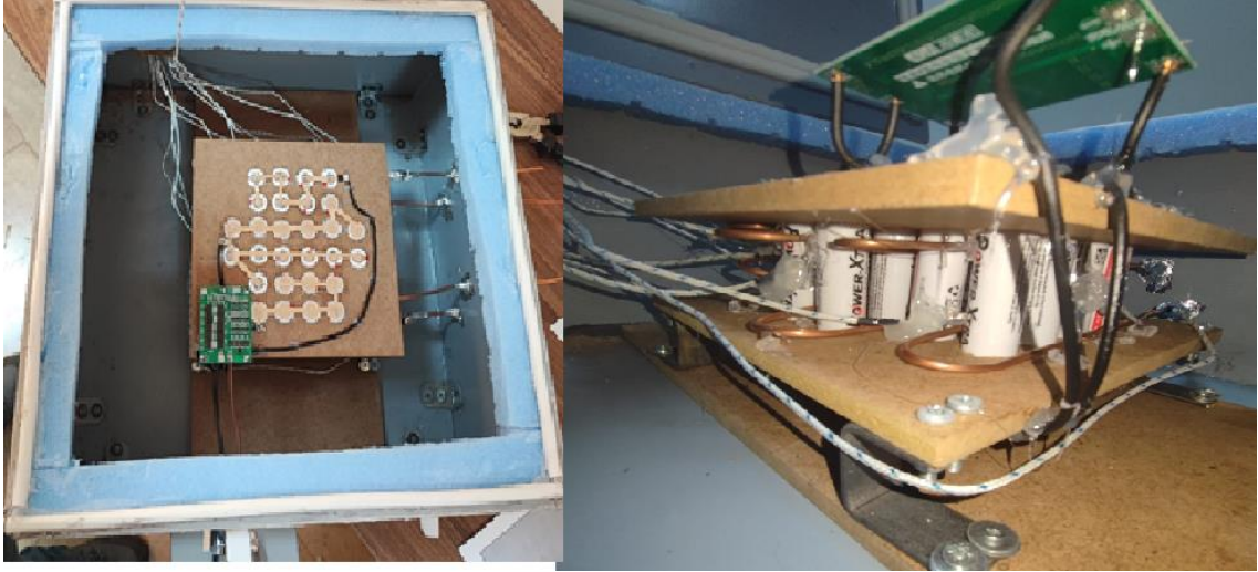
Şekil 3.15. İki borulu köşeli dizilime sahip batarya paketi
