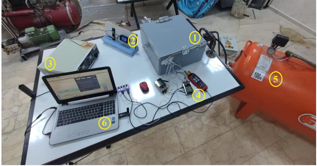
Şekil 3.16. Isı borulu deney düzeneği ve kullanılan ekipmanlar
