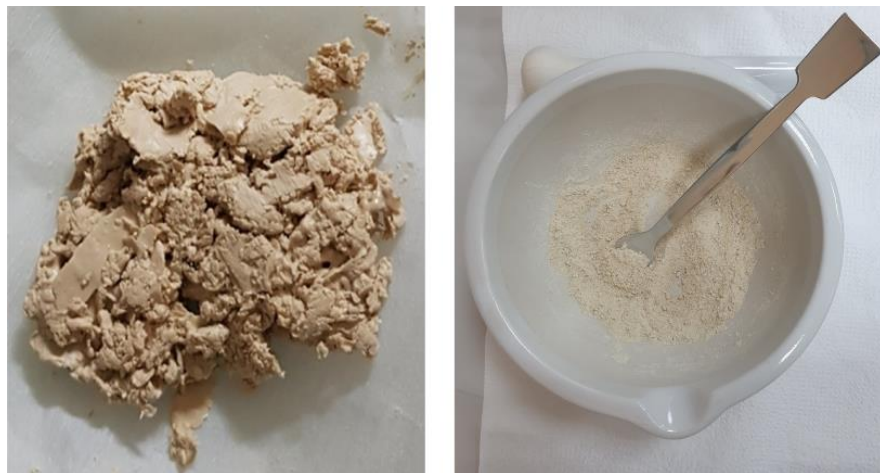
Şekil 7.2. Kompozit FDM CK40 (a) kurutma esnasında (b) kurutma ve öğütme sonrası
