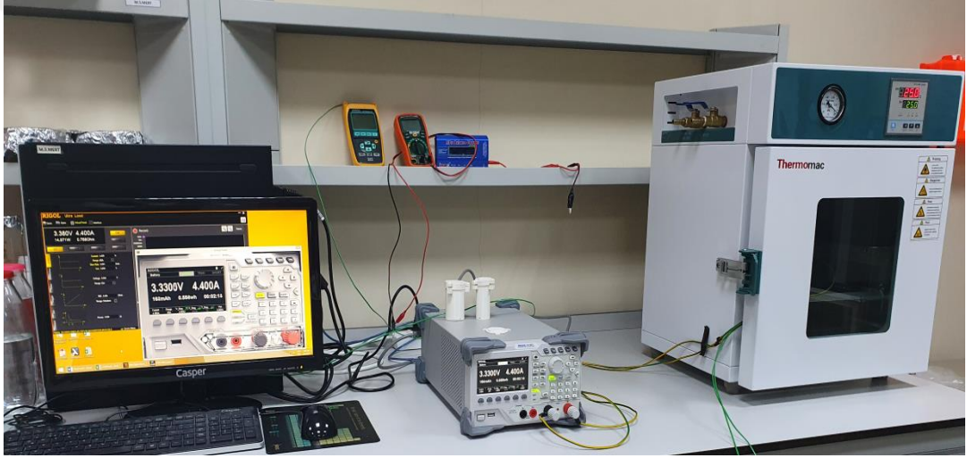
Şekil 7.1. Lityum iyon bataryanın şarj-deşarj uygulamaları deney seti
