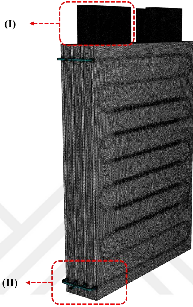
Şekil 3.14. Sıvı Soğutma ile BTYS çözüm ağı
