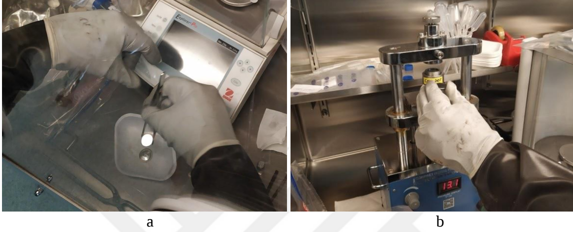
Resim 5.10. a) Pilin birleştirilmesi b) Pillerin sıkıştırılması
