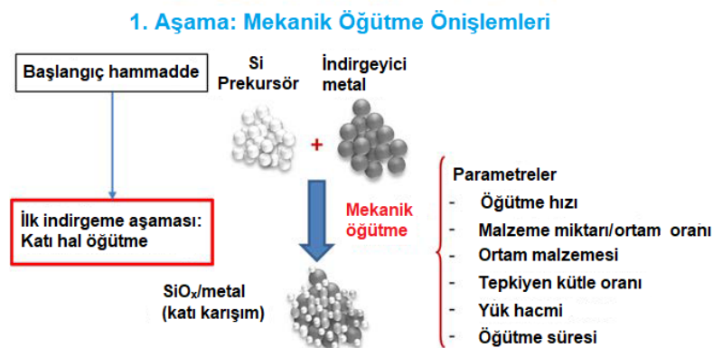
Şekil 4.28. Gözenekli Si eldesinde ilk aşama indirgeme/yükseltgenmenin şematik diyagramı [8]
