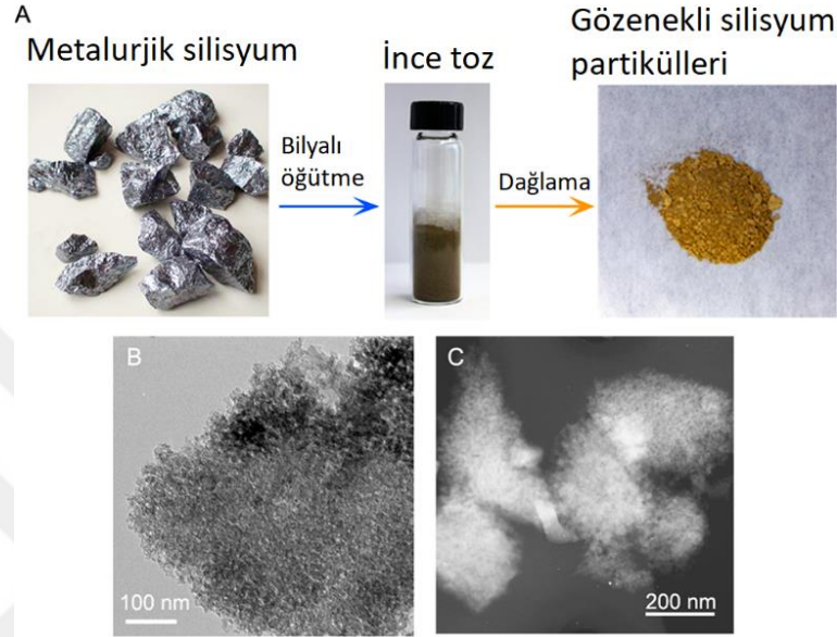
Şekil 4.36. Gözenekli silisyum partiküllerinin sentezi ve morfolojisi şeması (A) Metalurjik silisyumdan bilyalı öğütme ve dağlama işlemine kadar gözenekli silisyumun sentezlenmesi (B) Gözenekli Si partiküllerinin bir TEM görüntüsü (C) Nano gözenekli Si partiküllerinin STEM görüntüsü [209]
