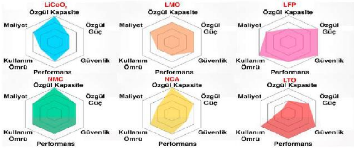
Şekil 2.6. Katot malzemelerin güç, kapasite, maliyet, güvenlik, performans ve kullanım ömrü özellikleri açısından karşılaştırılması (Keleş vd., 2024)
