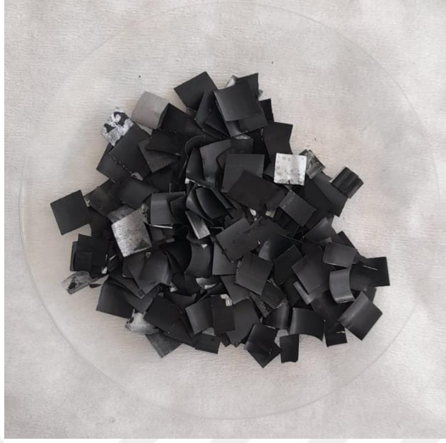
Şekil 6.4. 1 cm x 1 cm boyutlarında kesilmiş atık NMC LIB katodu
