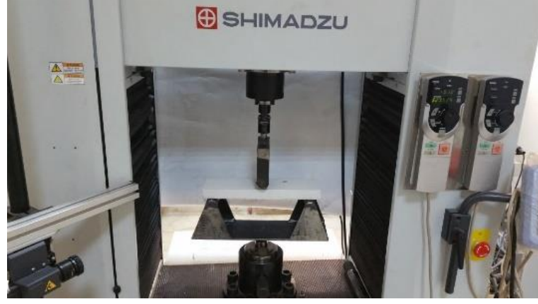
Şekil 3.5 Üç nokta eğme dayanım deneyi.
