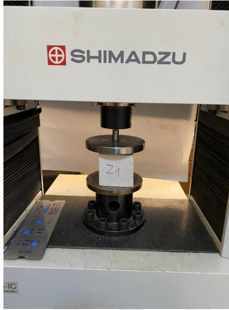
Şekil 3.4. Tek eksenli küp basınç dayanımı deneyi.
