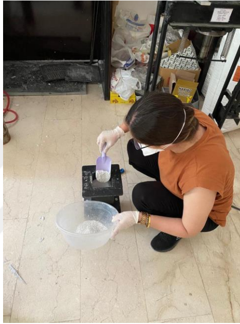
Şekil 3.2. Karışımların kalıplara doldurulması.
