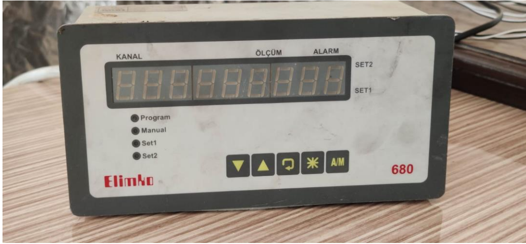
Şekil 3.8. Termocupların bağlandığı çok girişli datalogger.
