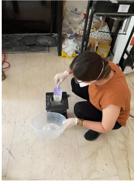
Şekil 3.2. Karışımların kalıplara doldurulması.
