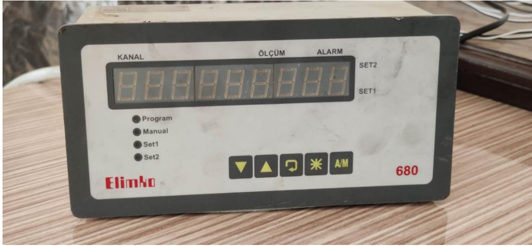
Şekil 3.8. Termocupların bağlandığı çok girişli datalogger.
