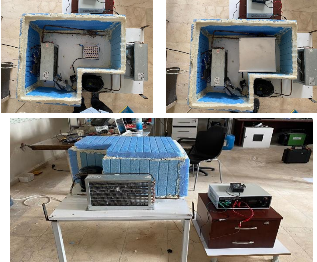
Şekil 3.13. Soğuk çalışma şartları için batarya test kabinin genel görünümü.
