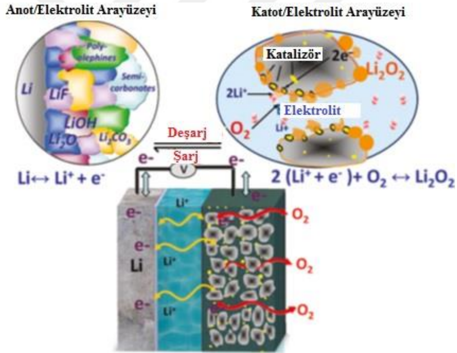
Şekil 2.8. Li-hava pil sistemi [57].
