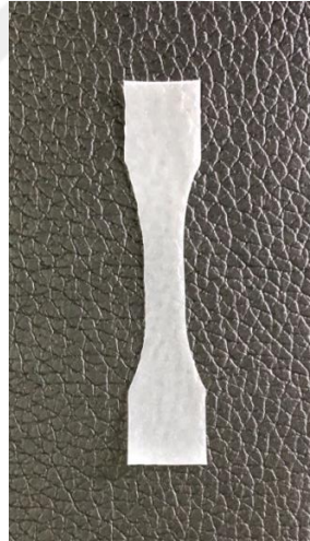
Şekil 4.8. Çekme testi için kemik şeklinde kesilen membran.
