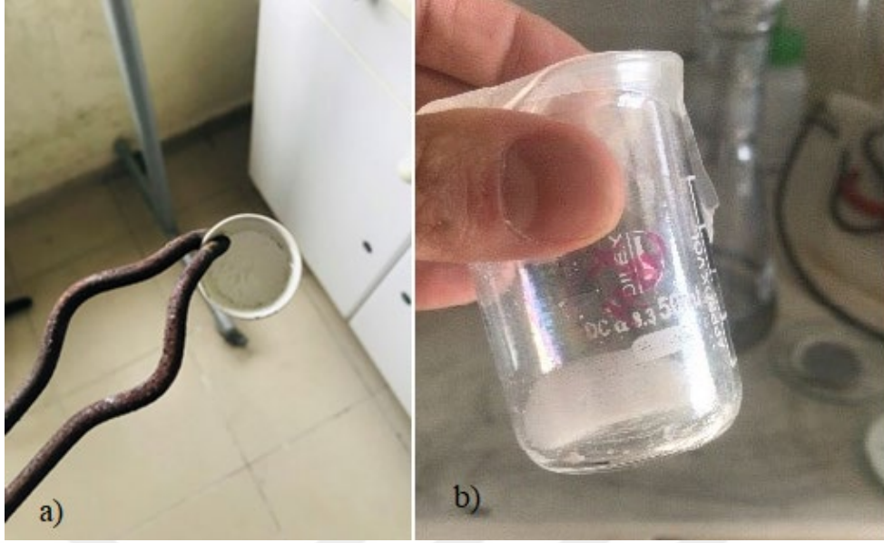
Şekil 4.3. a) Fırın atmosferinde yüksek ısı ile fonksiyonelleştirme çalışması. b) fonksiyonelleştirilmiş ve pul pul dökülmüş h-BN'nin sulu süspansiyonu.
