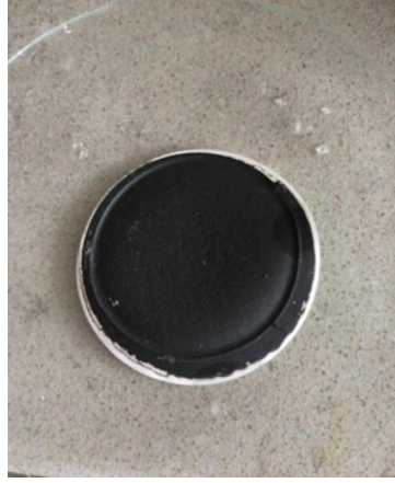
Şekil 4.5. Kâğıt şeklindeki esnek, serbest h-BN/rGO/S kompozit film.
