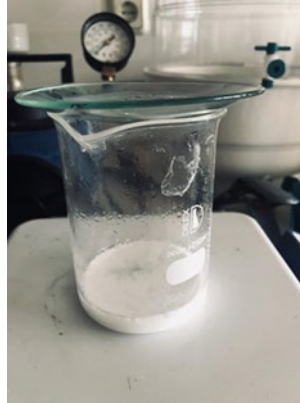
Şekil 4.2. Fonksiyonelleştirme çalışması, ısı ile 12 saat asit çözeltisinde muamele işlemi.
