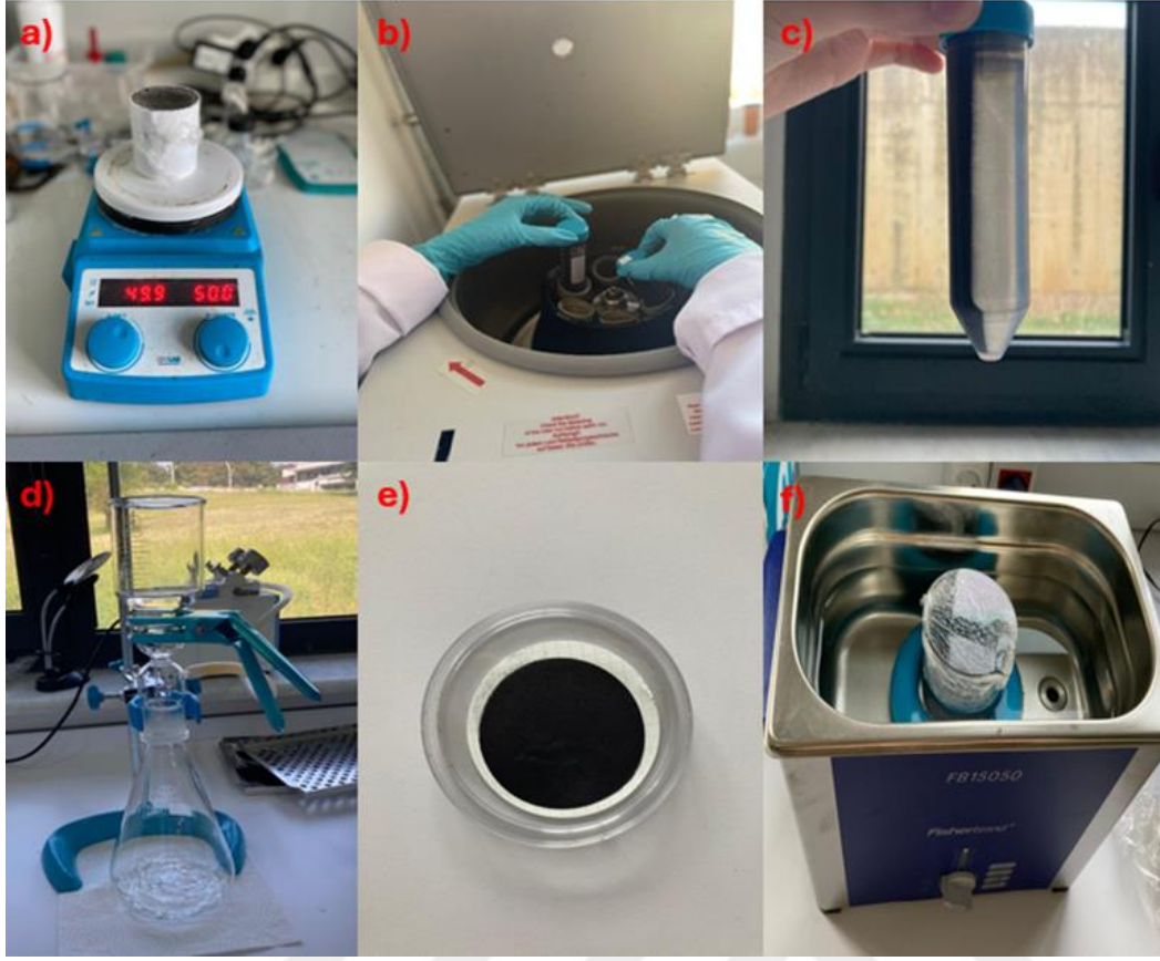
Şekil 4.1. a) manyetik karıştırma, b) ve c) santrifüj ve sonrasında elde edilen numune, d) filtrasyon işlemi, e) toplanan numune ve f) sonikasyon işlemi.
