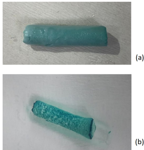
Şekil 3.6. MaBt-Cu-HEMA kriyojeli (a) şişmiş hali (b) kuru hali fotoğrafları
