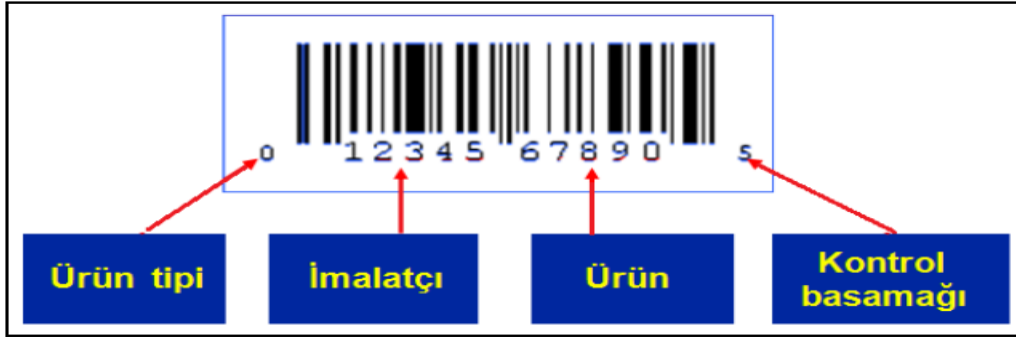
Şekil 3.1. UPC Tip Barkod Yapısı
