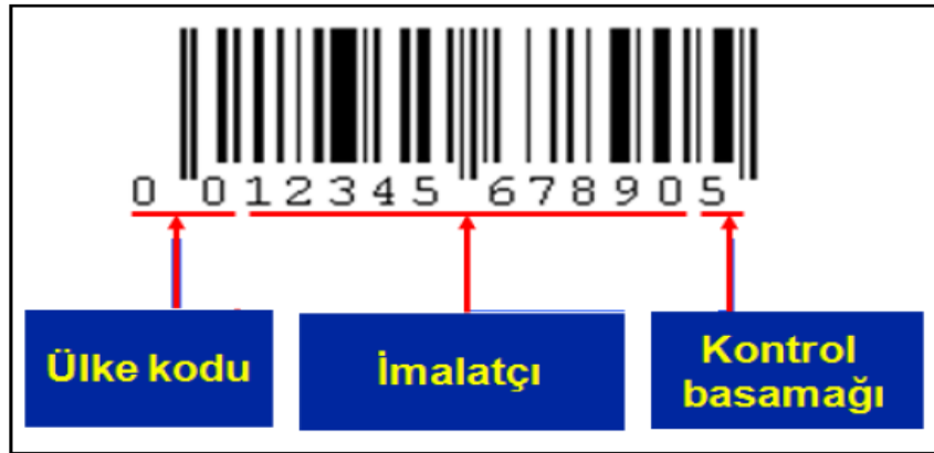
Şekil 3.2. EAN Tip Barkod Yapısı
