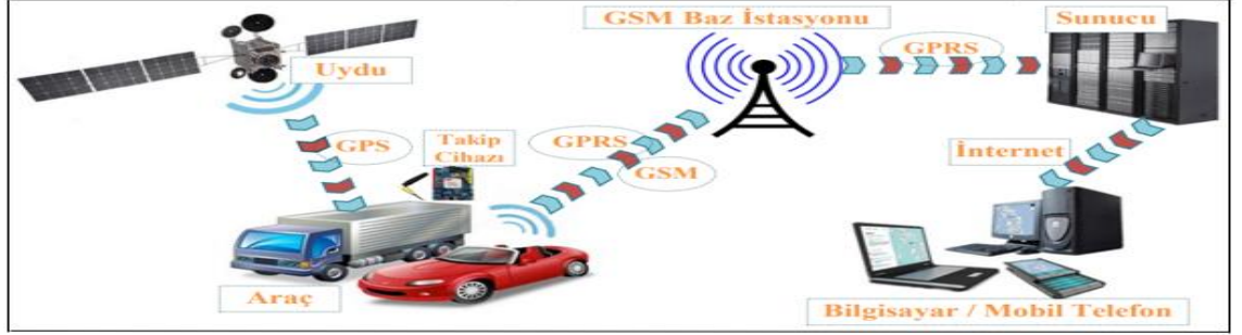
Şekil 4. Araç Takip Sisteminin Genel Çalışma Prensibi
