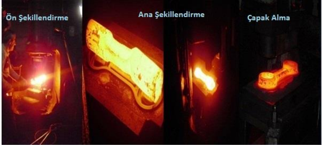
Şekil 2.3: Kapalı kalıpta sıcak dövme prosesinin temel aşamaları.
