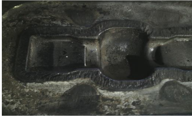
Şekil 5.13: Çapak hattı hasar görmüş bugi burcu kalıbı
