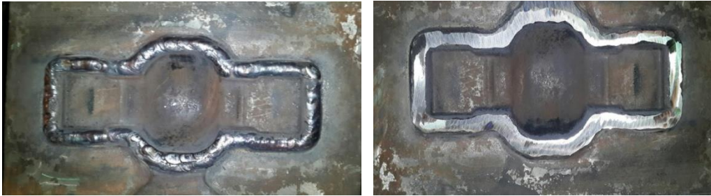
Şekil 5.14 : Lokal dolgu kaynağı çapak hattına tatbik edilmiş kalıp ve yüzey temizlenmiş kalıp
