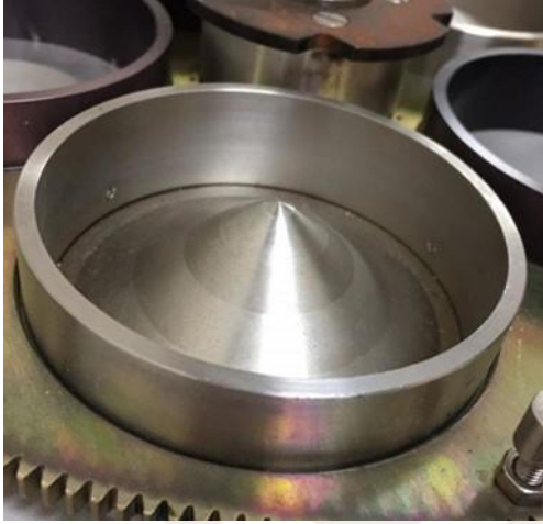
Şekil 2.10 Tungstenden yapılmış bir Düzleştirici Filtre
