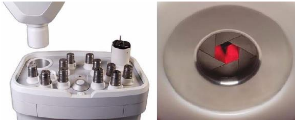
Şekil 3.3 CyberKinfe cihazına ait sabit ve İRİS kolimatör sistemi
