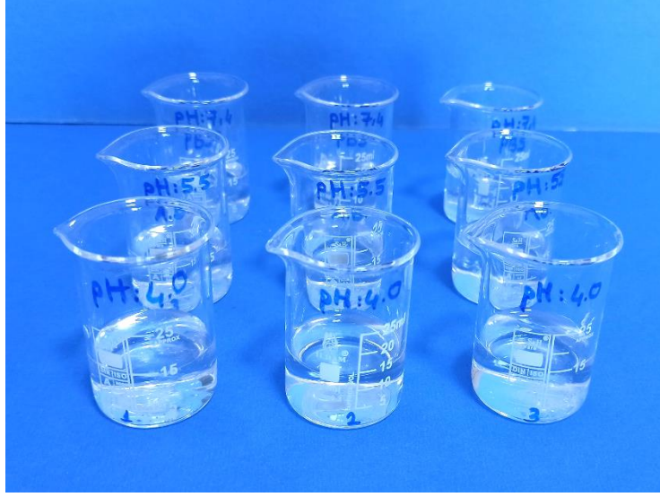
Resim 3.6 Su tutma kapasitesi test düzeneği.
