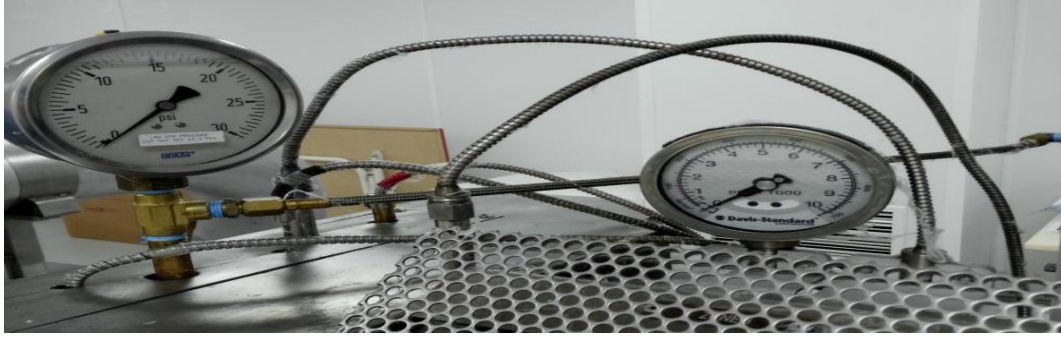
Şekil 3.5. Melt blown cihazındaki hava basınç göstergesi
