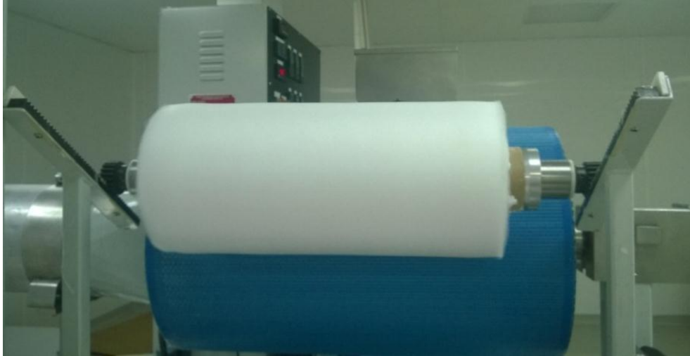
Şekil 3.6. Melt blown cihazındaki kollektör
