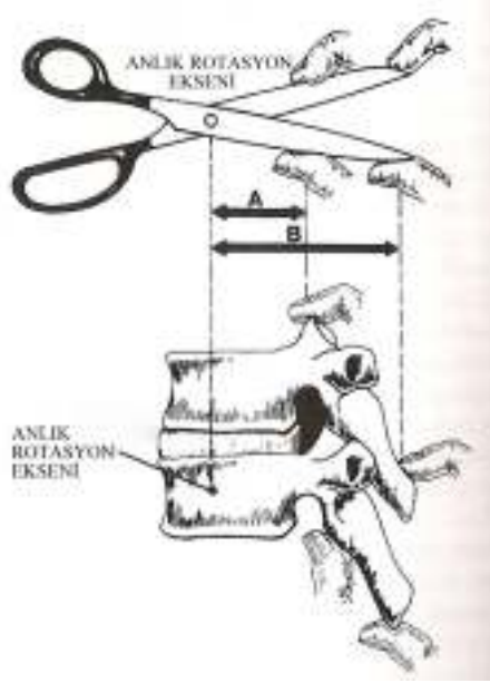
Şekil 4: Makasın kollarını açmak için uygulanması gereken kuvvet daha uzun kaldıraç koluna sahip olan B mesafesi için daha azdır. Aynı mantıkla, faset seviyesinden uygulanacak kuvvete göre daha az bir kuvvetin spinöz çıkıntılara uygulanması stabilite için yeterlidir. Çünkü B mesafesi ARE'ne daha uzak bir noktadadır ve kaldıraç kolu daha uzundur. Bu durum sağlam interspinöz ve supraspinöz bağların önemini de göstermektedir. (White AA, Panjabi MM: Clinical Biomechanics of the Spine. Philadelphia, JB Lippincott, 1990, s 533.)
