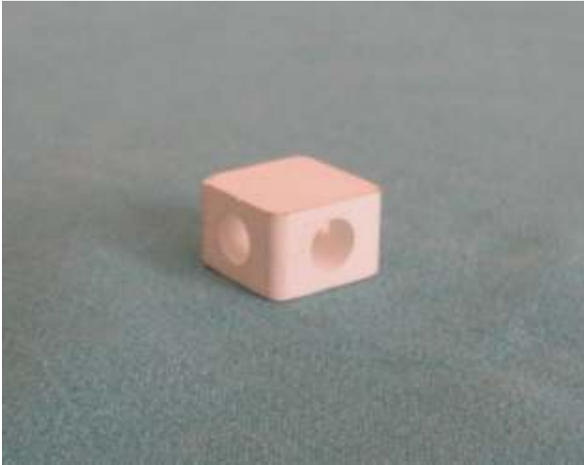
Şekil 41: Her iki yan yüzeyde 6 mm çapında delikleri bulunan kafes en uygun geometri olarak tespit edildi ve işlendi.
