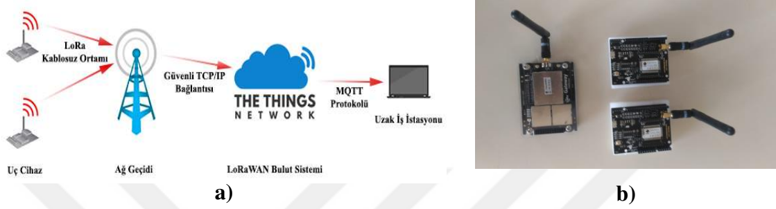
Şekil 4.31. Kurulumu ve entegrasyonu yapılan LoRaWAN sistemi (a) ve kullanılan cihazlar (b)
