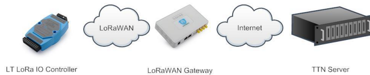
Şekil 4.1 I/O denetleyici ağ şeması
