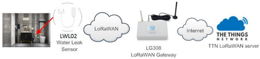
Şekil 4.9 Su sızıntı sensörü ağ şeması
