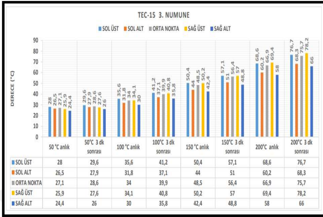
Şekil 5.4 TEC-15 camı 3. numune deney sonuçları
