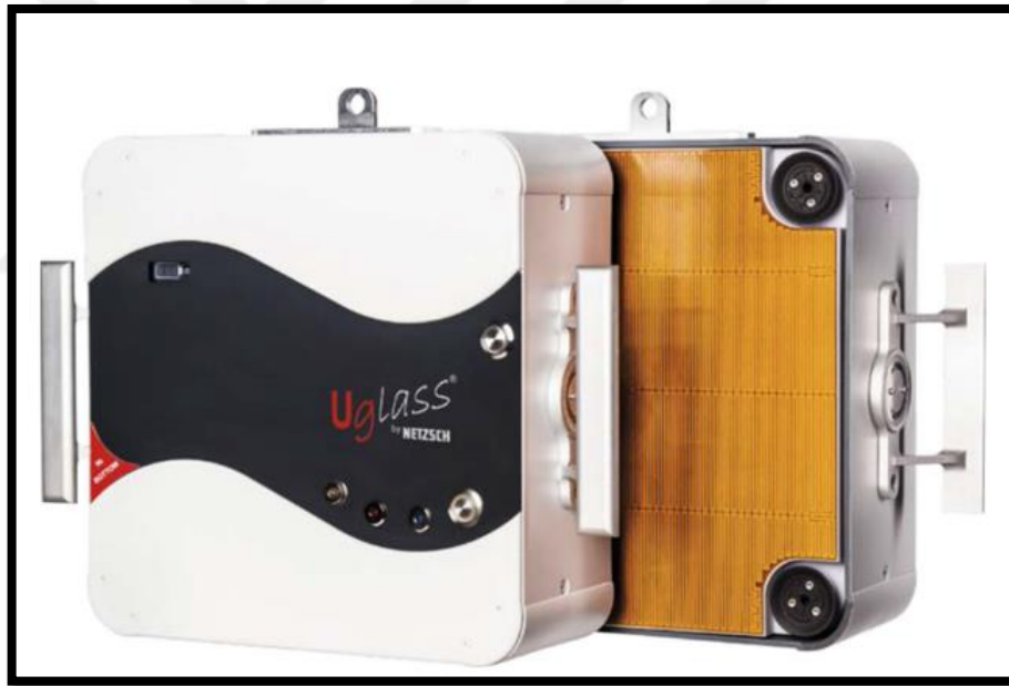
Şekil 2.2 Taşınabilir iletim katsayısı ölçer Netzsch Uglass cihazı ( Kim vd., 2018)
