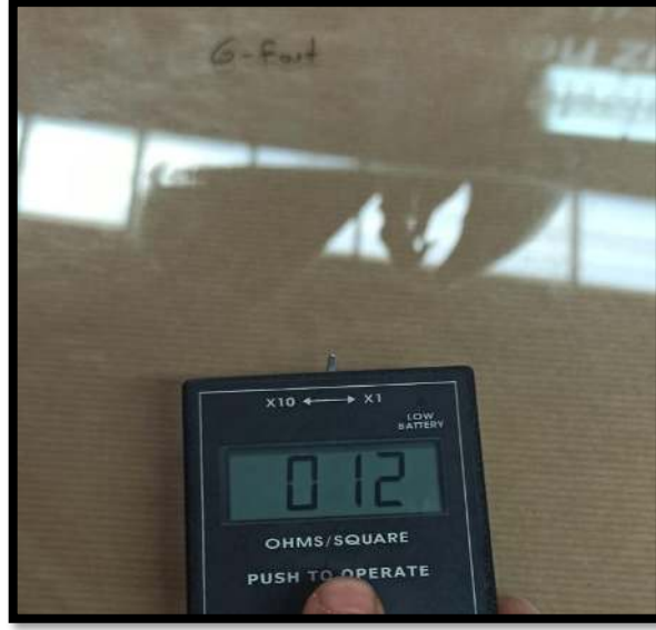
Fotoğraf 5.17 EDTM RC2175 cihazı temperleme sonrası G Fast camı yüzey direnç ölçümü sonucu
