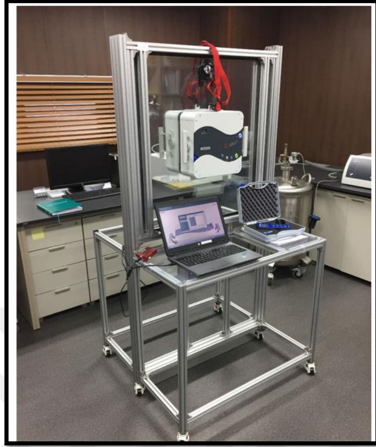
Fotoğraf 2.1 Low-e cam test ekipmanları (Kim vd., 2018)
