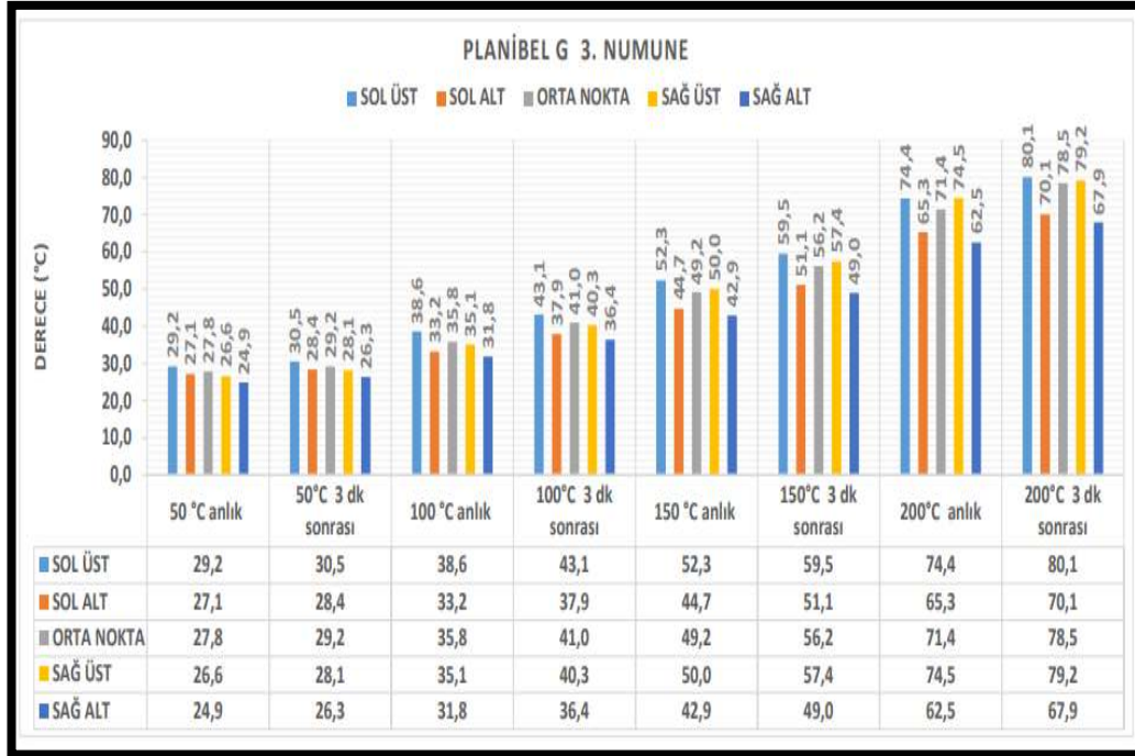
Şekil 5.12 Planibel G camı 3. numune deney sonuçları
