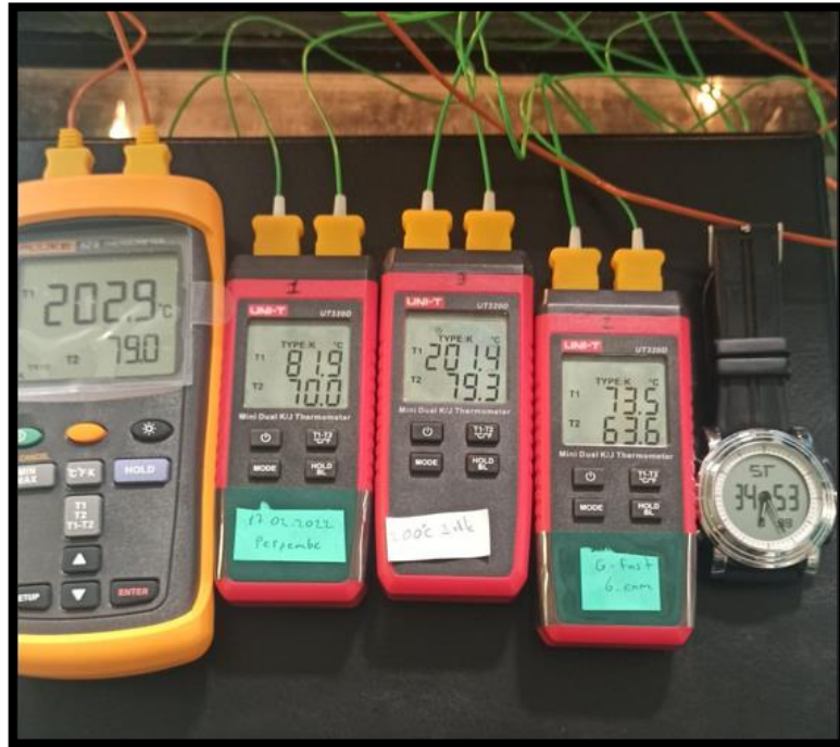
Fotoğraf 5.7 Camların sıcaklıklarını ölçmek için kullanılan cihazlar
