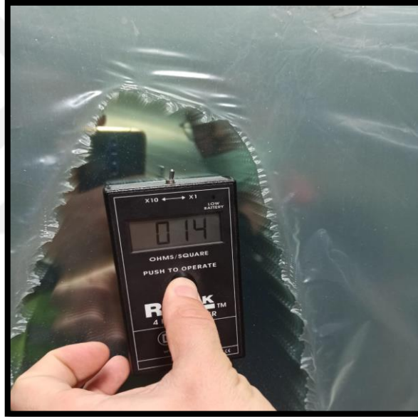
Fotoğraf 5.16 EDTM RC2175 cihazı temperleme öncesi G Fast camı yüzey direnç ölçümü sonucu
