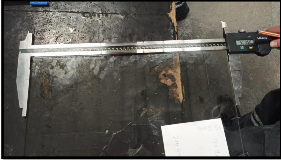
Fotoğraf 5.3 Kesim işlemi yapılan camların rodaj işlemi öncesi genişlik ölçüsü (mm)
