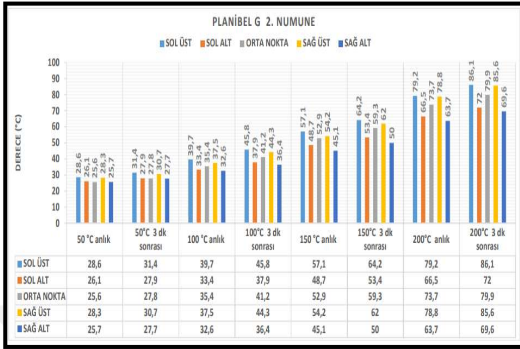
Şekil 5.11 Planibel G camı 2. numune deney sonuçları
