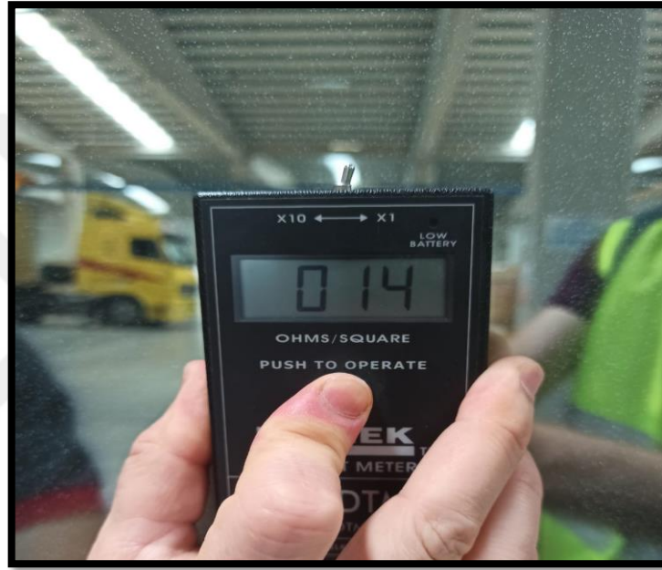
Fotoğraf 5.14 EDTM RC2175 cihazı temperleme öncesi Planibel G camı yüzey direnç ölçümü sonucu
