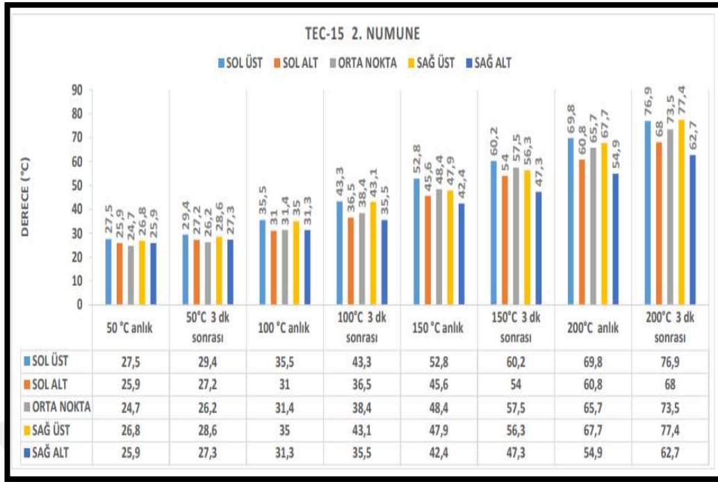
Şekil 5.3 TEC-15 camı 2. numune deney sonuçları
