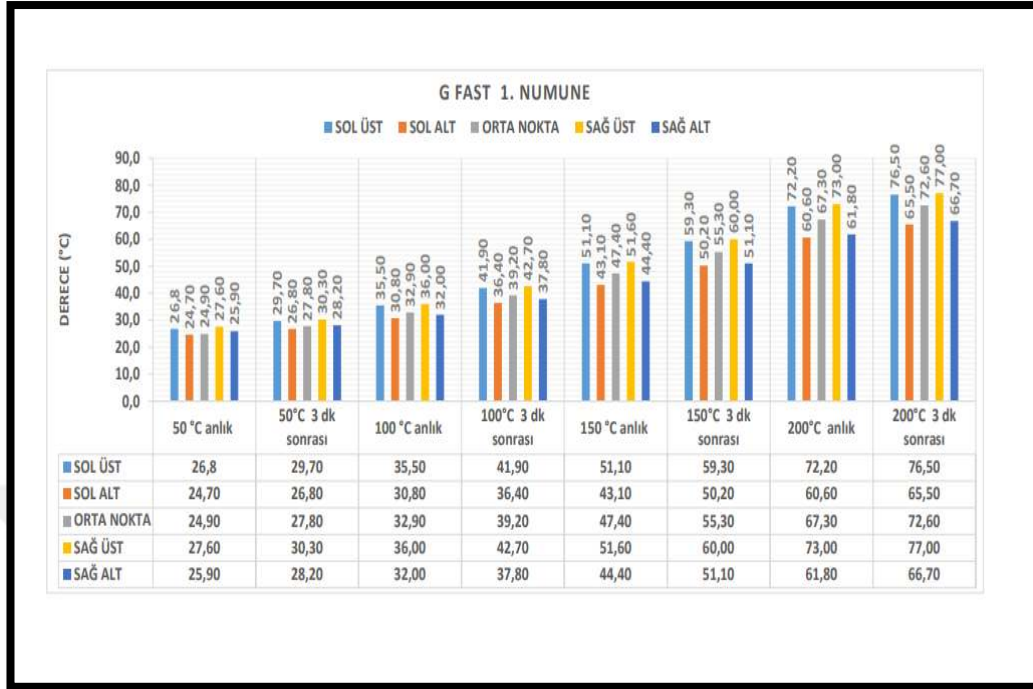
Şekil 5.18 G Fast camı 1. numune deney sonuçları
