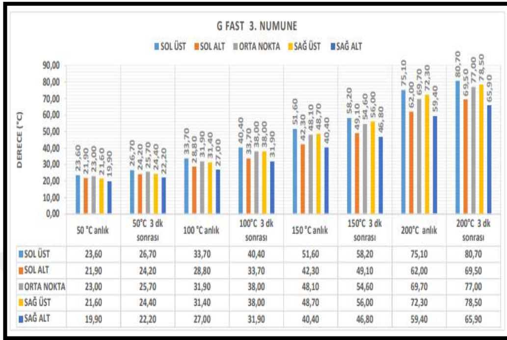
Şekil 5.20 G Fast camı 3. numune deney sonuçları
