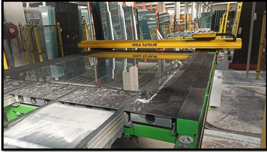
Fotoğraf 5.1 Numunelerin kesilmesi için kullanılan cihaz Hegla Rapidline
