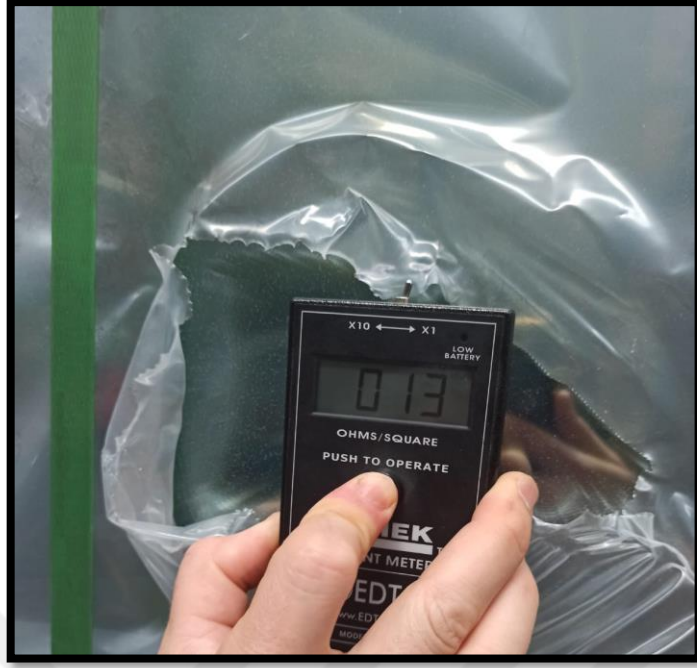
Fotoğraf 5.12 EDM RC2175 cihazı temperleme öncesi TEC-15 camı yüzey direnç ölçümü sonucu
