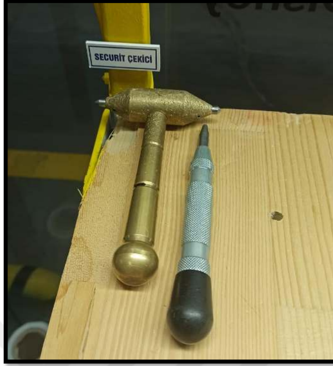
Fotoğraf 5.9 Kırılma testi için kullanılan securit çekiçi ve cam kırıcı aparat
