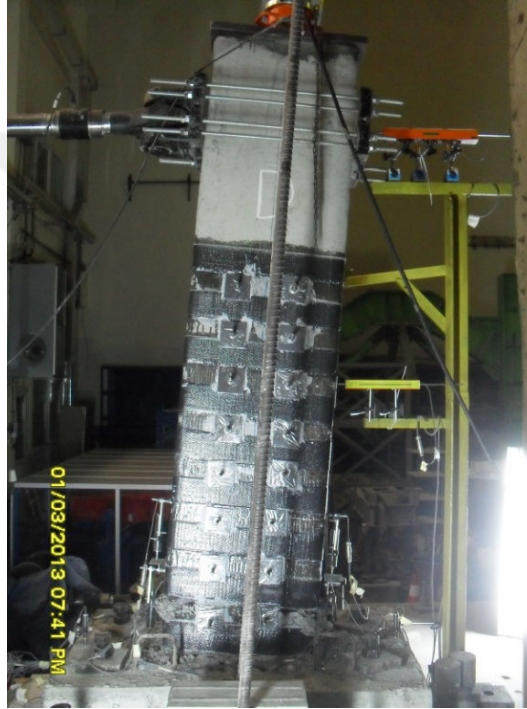
Şekil 4.58 : \pm 0.08 görelî ötelemede itme ve çekmede genel görünüş.
