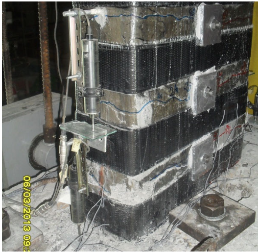
Şekil 4.36 : +0.05 görelî ötelemede çekme ve basınç bölgelerinde hasar durumu.
