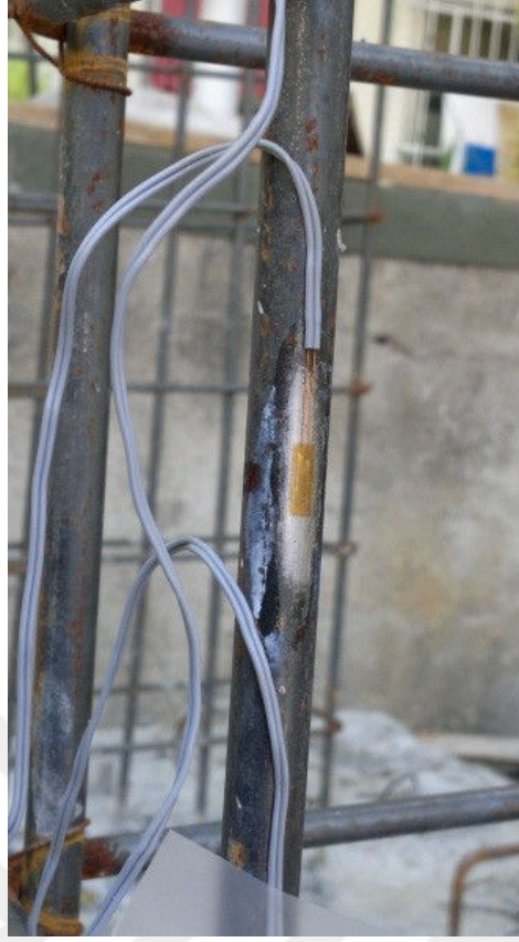
Şekil 2.4 : Şekil deęiřtirme ۆlerlerin yapıřtırılması.
