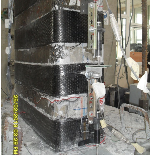
Şekil 4.35 : -0.04 görelî ötelemede çekme ve basınç bölgelerinde hasar durumu.
