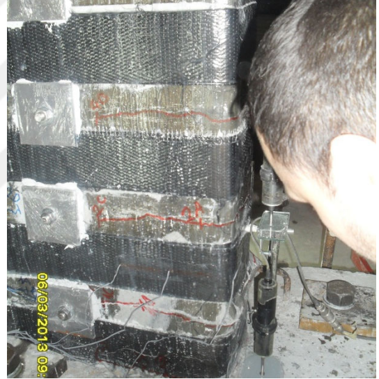
Şekil 4.35 : -0.04 görelî ötelemede çekme ve basınç bölgelerinde hasar durumu.
