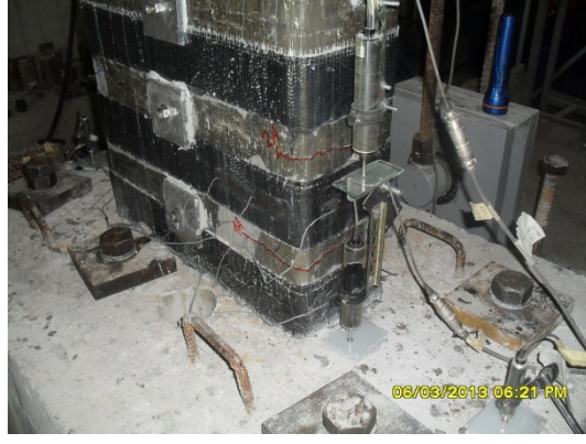
Şekil 4.31 : \pm 0.0025 görelî ötelemede oluşan ilk çatlaklar.
