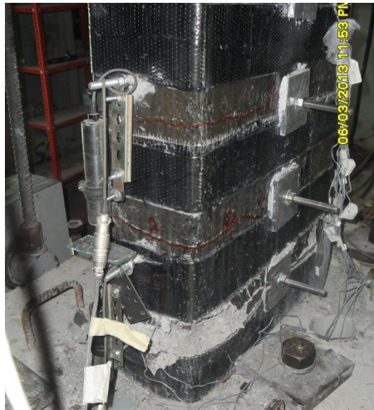
Şekil 4.44 : Kalıcı yer değiştirmede hasar durumu.
