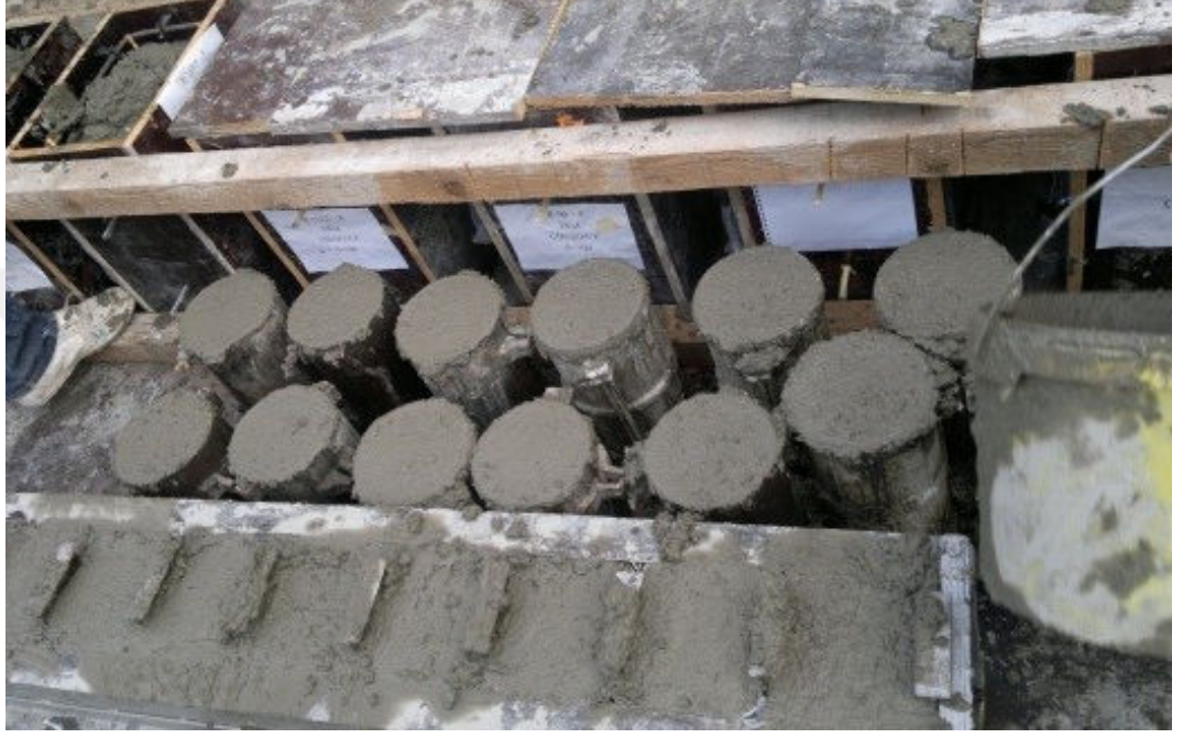
Şekil 2.10 : Deney numuneleri ile aynı ortamda saklanan beton numuneleri.
