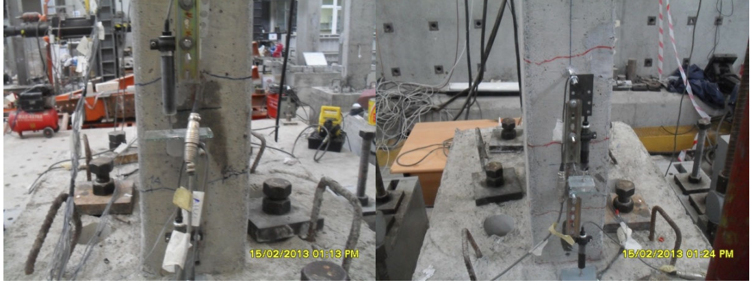
Şekil 4.2 : \pm 0.0075 görelî ötelemede çatlak oluşumu.
