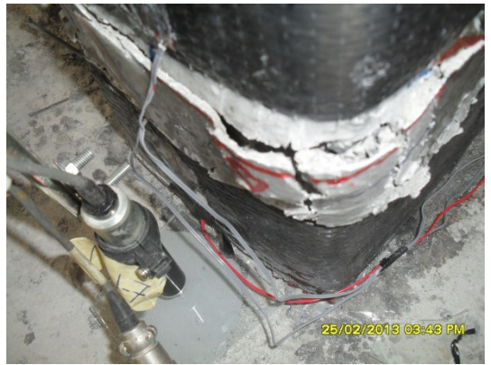
Şekil 4.21 : +0.035 görelî ötelemede çekme ve basınç bölgesinde hasar durumu.
