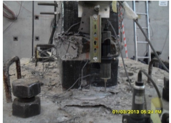
Şekil 4.53 : -0.05 görelî ötelemde çekme ve basınç bölgesinde hasar durumu.
