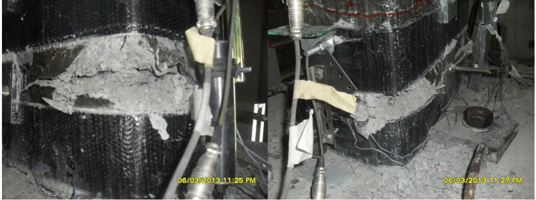
Şekil 4.41 : +0.08 görelî ötelemede çekme ve basınç bölgesinde hasar durumu.
