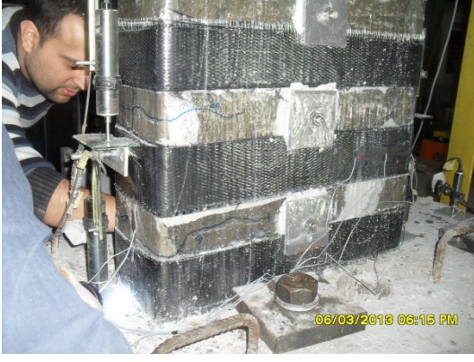
Şekil 4.31 : \pm 0.0025 görelî ötelemede oluşan ilk çatlaklar.
