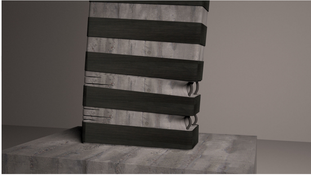
Şekil 5.11 : 20x60_4N numunesi temsili plastik mafsall bölgesi.
