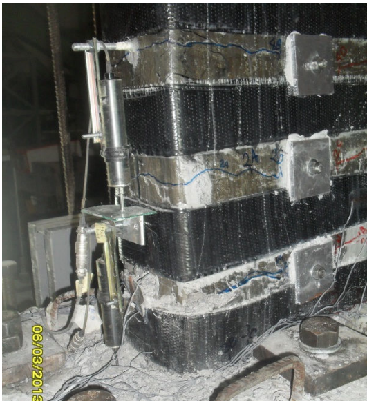
Şekil 4.44 : Kalıcı yer değiştirmede hasar durumu.
