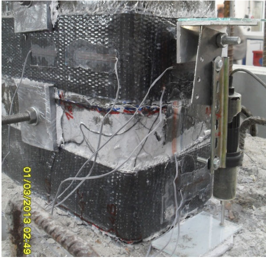
Şekil 4.49 : -0.02 görelî ötelemede hasar durumu ve ilk basınç çatlakları.
