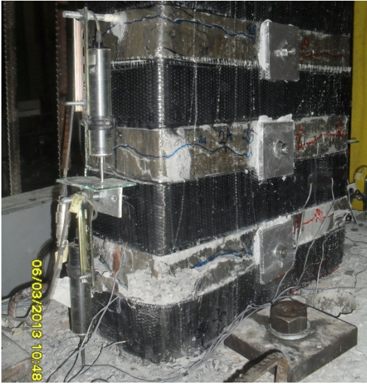
Şekil 4.38 : +0.07 görelî ötelemede çekme ve basınç bölgesinde hasar durumu.
