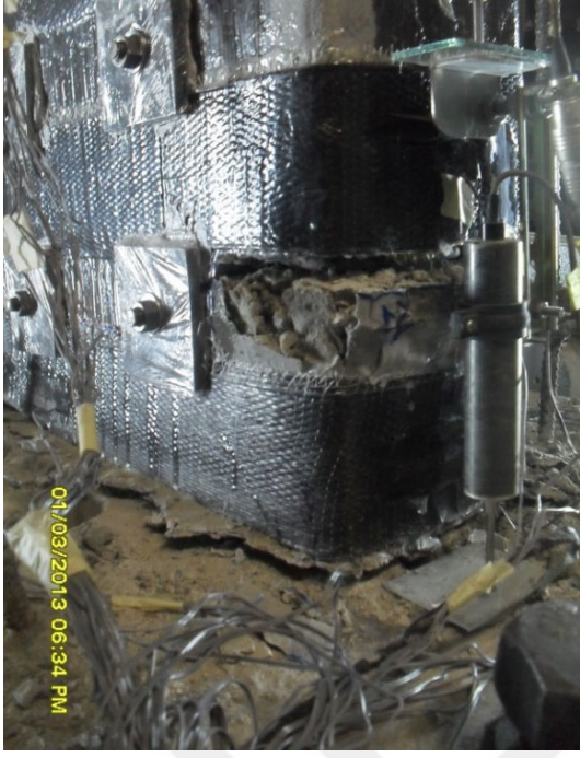
Şekil 4.54 : +0.07 görelî ötelemede çekme ve basınç bölgesinde hasar durumu.
