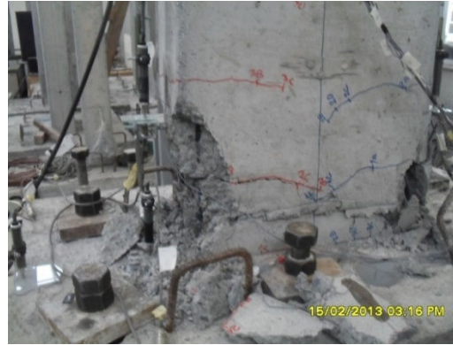
Şekil 4.11 : -0.03 görelî ötelenmede hasar durumu ve donatı burkulması.
