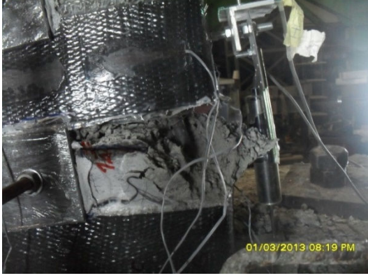
Şekil 4.57 : -0,08 görelî ötelemede çekme ve basınç bölgesinde hasar durumu.
