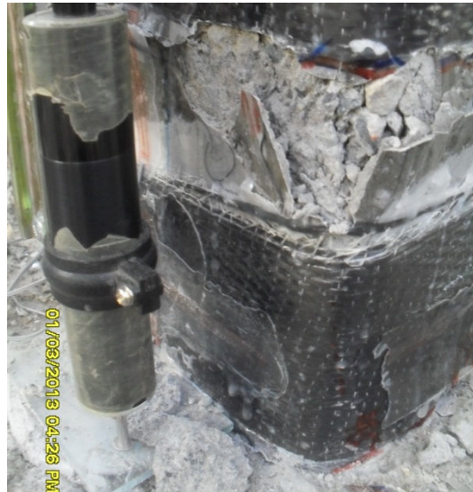
Şekil 4.50 : +0.040 görelî ötelemede çekme ve basınç bölgelerinde hasar durumu.
