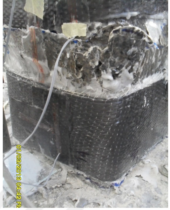
Şekil 4.51 : -0.04 görelî ötelemde çekme ve basınç bölgelerinde hasar durumu.
