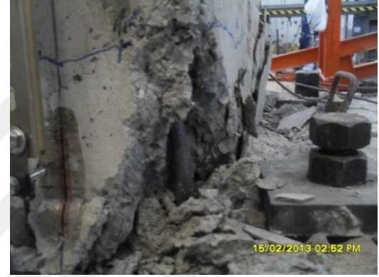
Şekil 4.9 : -0.025 görelî ötelemede hasar durumu ve donatı burkulması.
