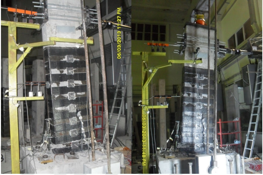
Şekil 4.40 : \pm 0.08 görelî ötelemede itme ve çekmede genel görünüş.
