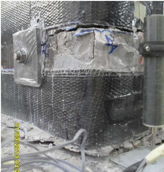
Şekil 4.50 : +0.040 görelî ötelemede çekme ve basınç bölgelerinde hasar durumu.
