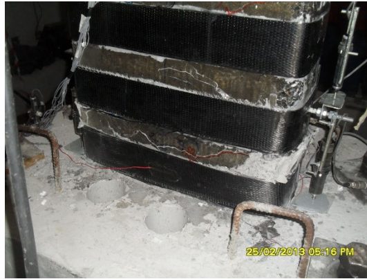
Şekil 4.28 : Kalıcı yer değiştirmede hasar durumu.
