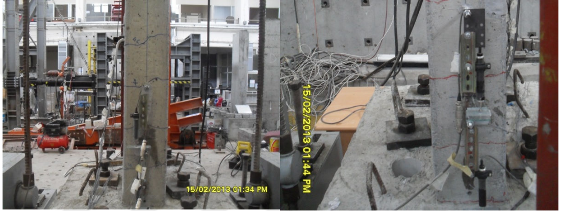
Şekil 4.3 : \pm 0.01 görelî ötelemede çatlak oluşumu.
