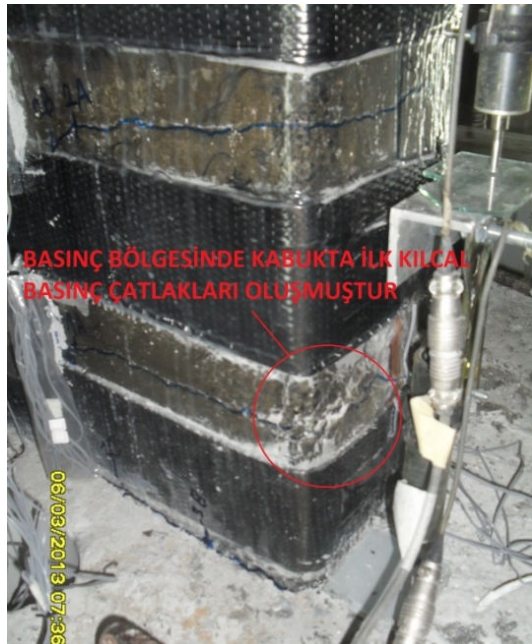
Şekil 4.33 : -0.02 görelî ötelemede hasar durumu ve ilk basınç çatlakları.
