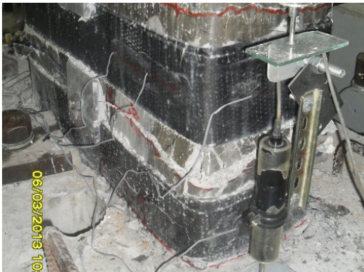
Şekil 4.53 : -0.05 görelî ötelemde çekme ve basınç bölgesinde hasar durumu.
