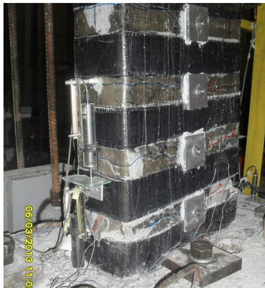
Şekil 4.39 : -0.07 görelî ötelemede çekme ve basınç bölgesinde hasar durumu.
