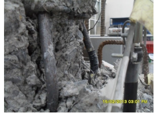
Şekil 4.10 : +0.03 görelî ötelenmede hasar durumu ve donatı burkulması.
