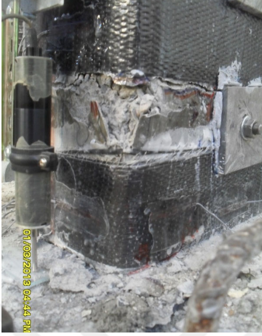
Şekil 4.51 : -0.04 görelî ötelemde çekme ve basınç bölgelerinde hasar durumu.
