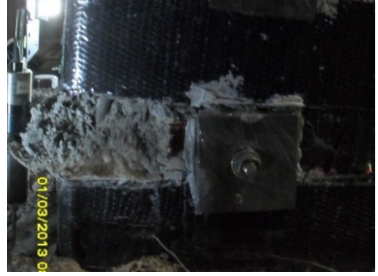
Şekil 4.57 : -0,08 görelî ötelemede çekme ve basınç bölgesinde hasar durumu.
