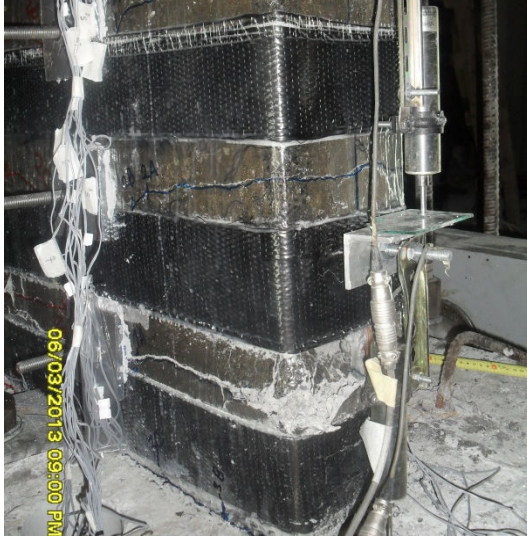
Şekil 4.34 : +0.040 görelî ötelemede çekme ve basınç bölgelerinde hasar durumu.
