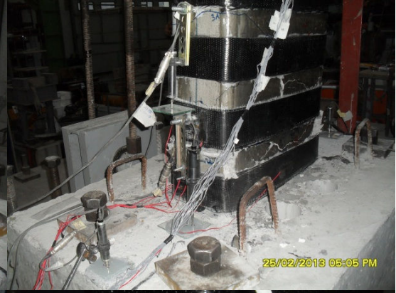
Şekil 4.25 : -0.04 görelî ötelemede çekme ve basınç bölgesinde hasar durumu.
