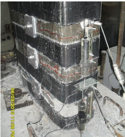
Şekil 4.39 : -0.07 görelî ötelemede çekme ve basınç bölgesinde hasar durumu.
