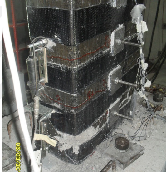
Şekil 4.38 : +0.07 görelî ötelemede çekme ve basınç bölgesinde hasar durumu.
