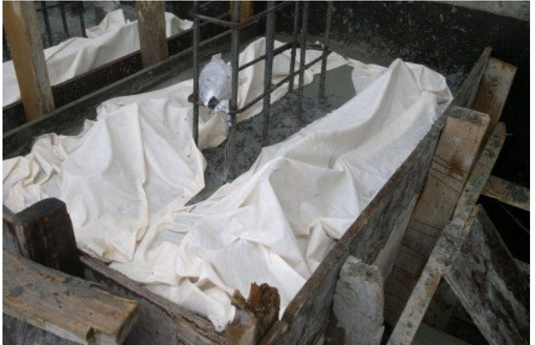
Şekil 2.11 : Deney numunesi kürlenmesi.
