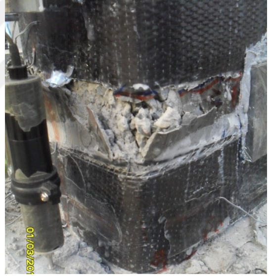
Şekil 4.52 : +0.05 görelî ötelemde çekme ve basınç bölgelerinde hasar durumu.
