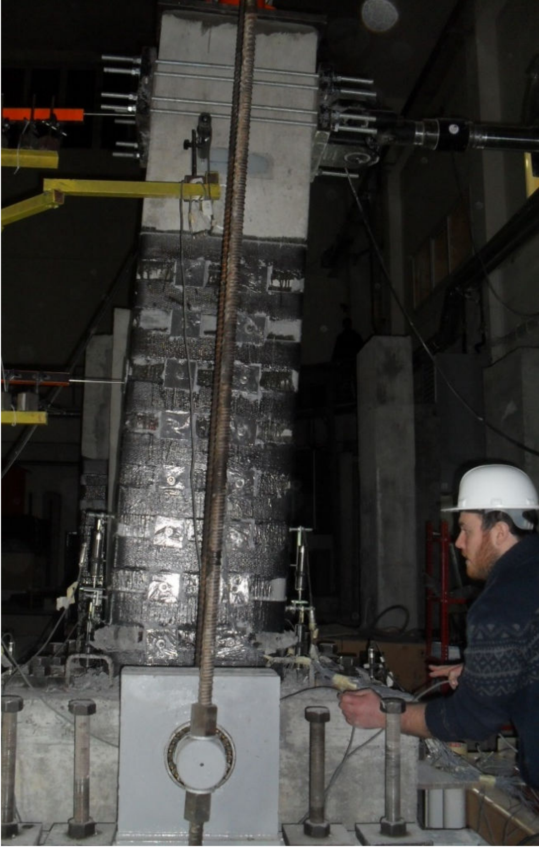
Şekil 4.60 : Yatay yük sıfır, kalıcı yer değıştirme 104 mm.
