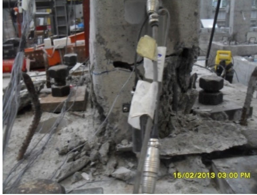
Şekil 4.10 : +0.03 görelî ötelenmede hasar durumu ve donatı burkulması.
