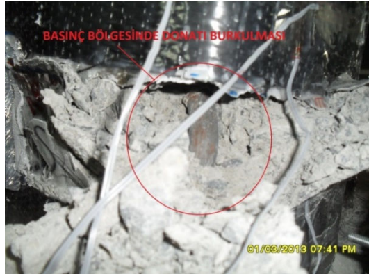
Şekil 4.56 : +0.08 görelî ötelemede hasar durumu ve donatı burkulması.
