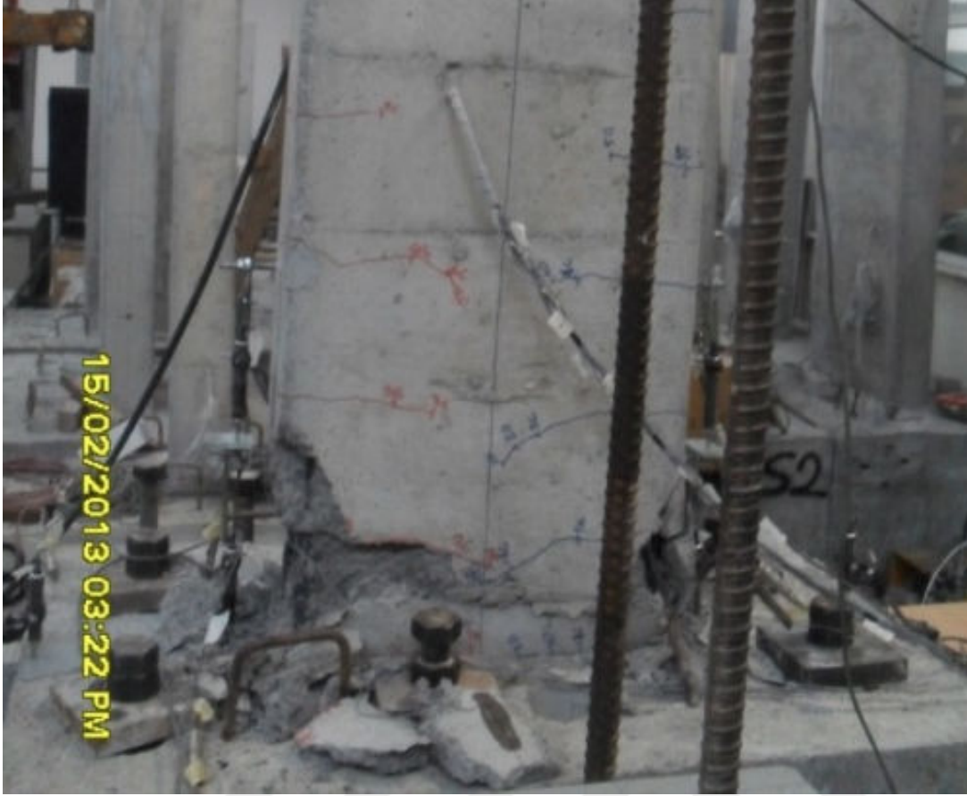
Şekil 4.12 : Yatay yük sıfırken kalıcı yer değiştirme 54.2 mm.
