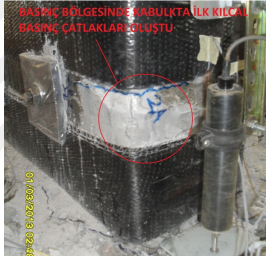
Şekil 4.49 : -0.02 görelî ötelemede hasar durumu ve ilk basınç çatlakları.
