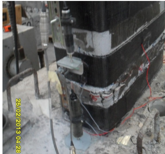
Şekil 4.24 : +0.04 görelî ötelemede çekme ve basınç bölgesinde hasar durumu.
