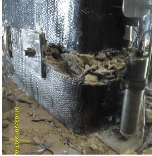
Şekil 4.55 : -0.07 görelî ötelemede çekme ve basınç bölgesinde hasar durumu.
