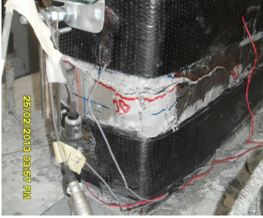
Şekil 4.22 : -0.035 görelî ötelemede çekme ve basınç bölgesinde hasar durumu.
