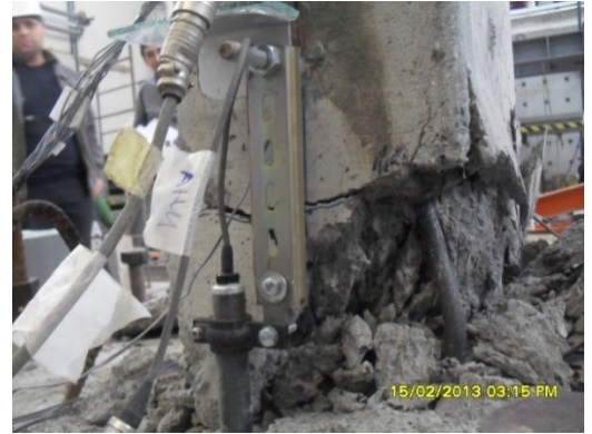
Şekil 4.11 : -0.03 görelî ötelenmede hasar durumu ve donatı burkulması.
