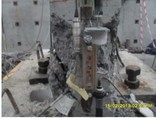
Şekil 4.9 : -0.025 görelî ötelemede hasar durumu ve donatı burkulması.
