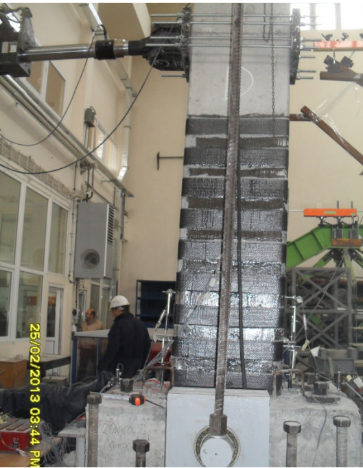
Şekil 4.23 : \pm 0.035 görelî ötelemede itme ve çekmede numunenin genel durumu.
