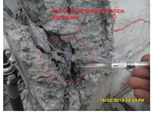
Şekil 4.8 : +0.025 görelî ötelemede hasar durumu ve donatı burkulması.
