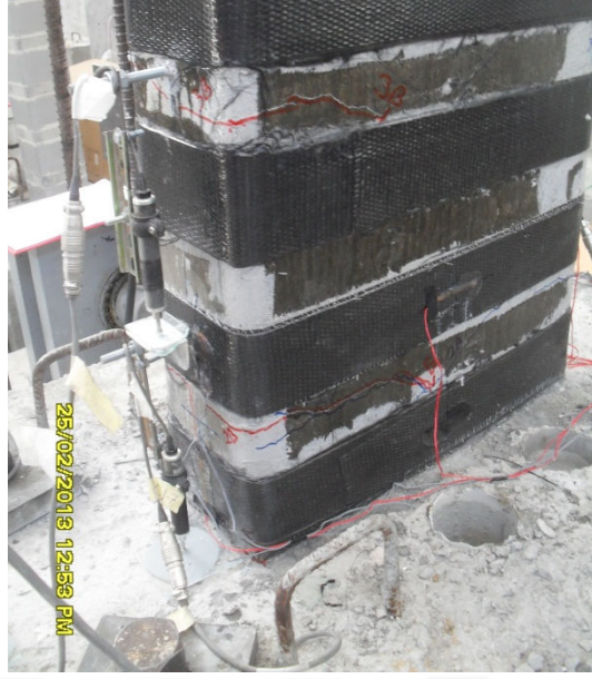
Şekil 4.16 : \pm 0.005 görelî ötelemede oluşan ilk çatlaklar.
