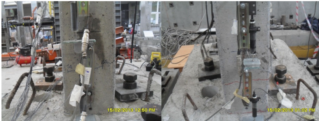
Şekil 4.1 : \pm 0.005 görelî ötelemede çatlak oluşumu.
