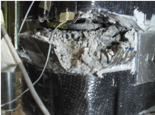
Şekil 4.56 : +0.08 görelî ötelemede hasar durumu ve donatı burkulması.
