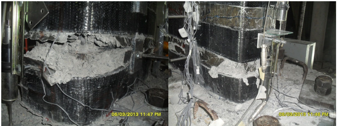
Şekil 4.42 : -0.08 görelî ötelemede çekme ve basınç bölgesinde hasar durumu.
