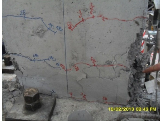
Şekil 4.8 : +0.025 görelî ötelemede hasar durumu ve donatı burkulması.
