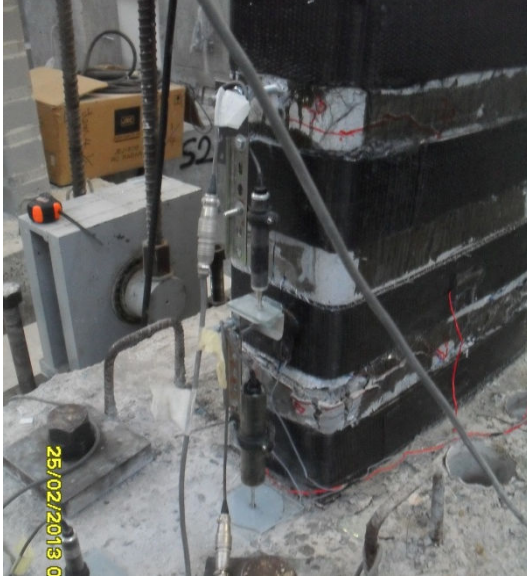
Şekil 4.25 : -0.04 görelî ötelemede çekme ve basınç bölgesinde hasar durumu.
