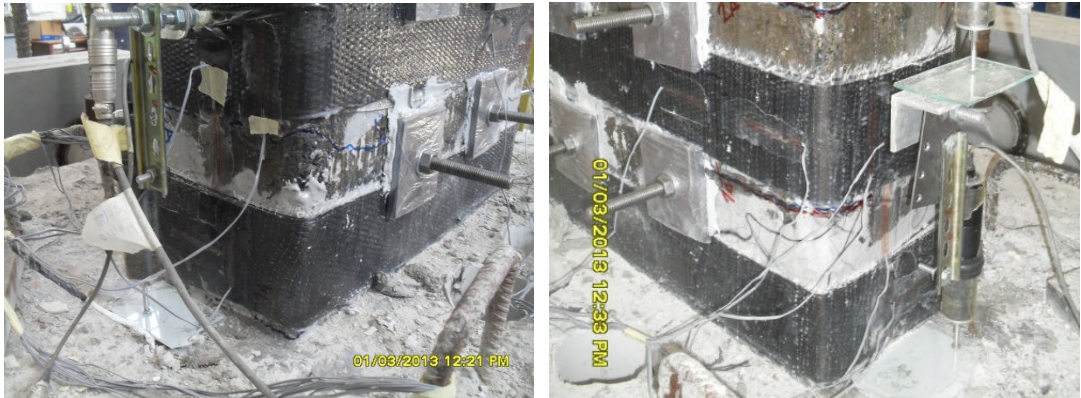
Şekil 4.47 : \pm 0.0025 görelî ötelemede oluşan ilk çatlaklar.
