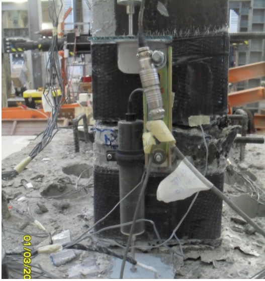
Şekil 4.52 : +0.05 görelî ötelemde çekme ve basınç bölgelerinde hasar durumu.
