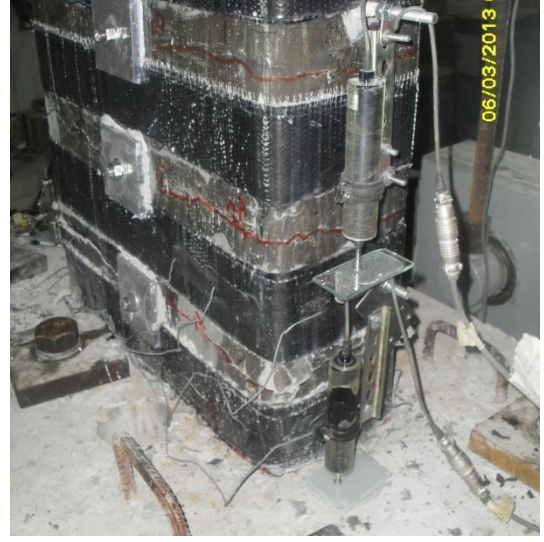
Şekil 4.34 : +0.040 görelî ötelemede çekme ve basınç bölgelerinde hasar durumu.
