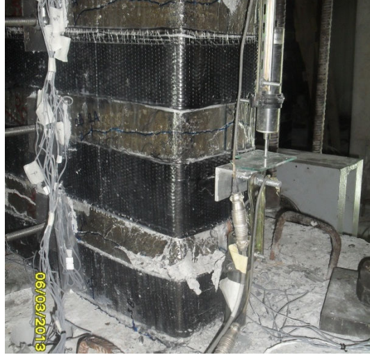
Şekil 4.37 : -0.05 görelî ötelemede çekme ve basınç bölgesinde hasar durumu.
