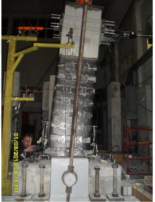
Şekil 4.58 : \pm 0.08 görelî ötelemede itme ve çekmede genel görünüş.
