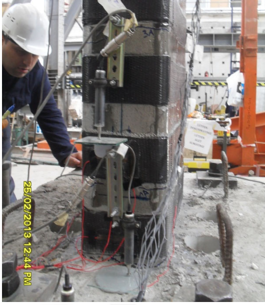
Şekil 4.16 : \pm 0.005 görelî ötelemede oluşan ilk çatlaklar.
