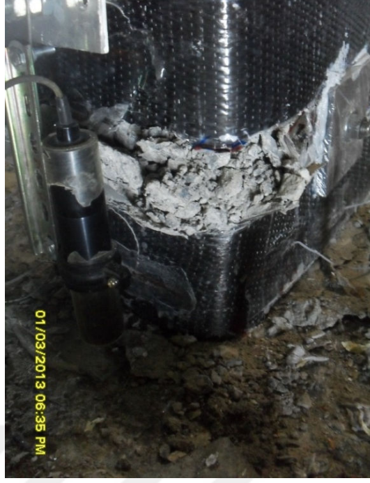
Şekil 4.54 : +0.07 görelî ötelemede çekme ve basınç bölgesinde hasar durumu.
