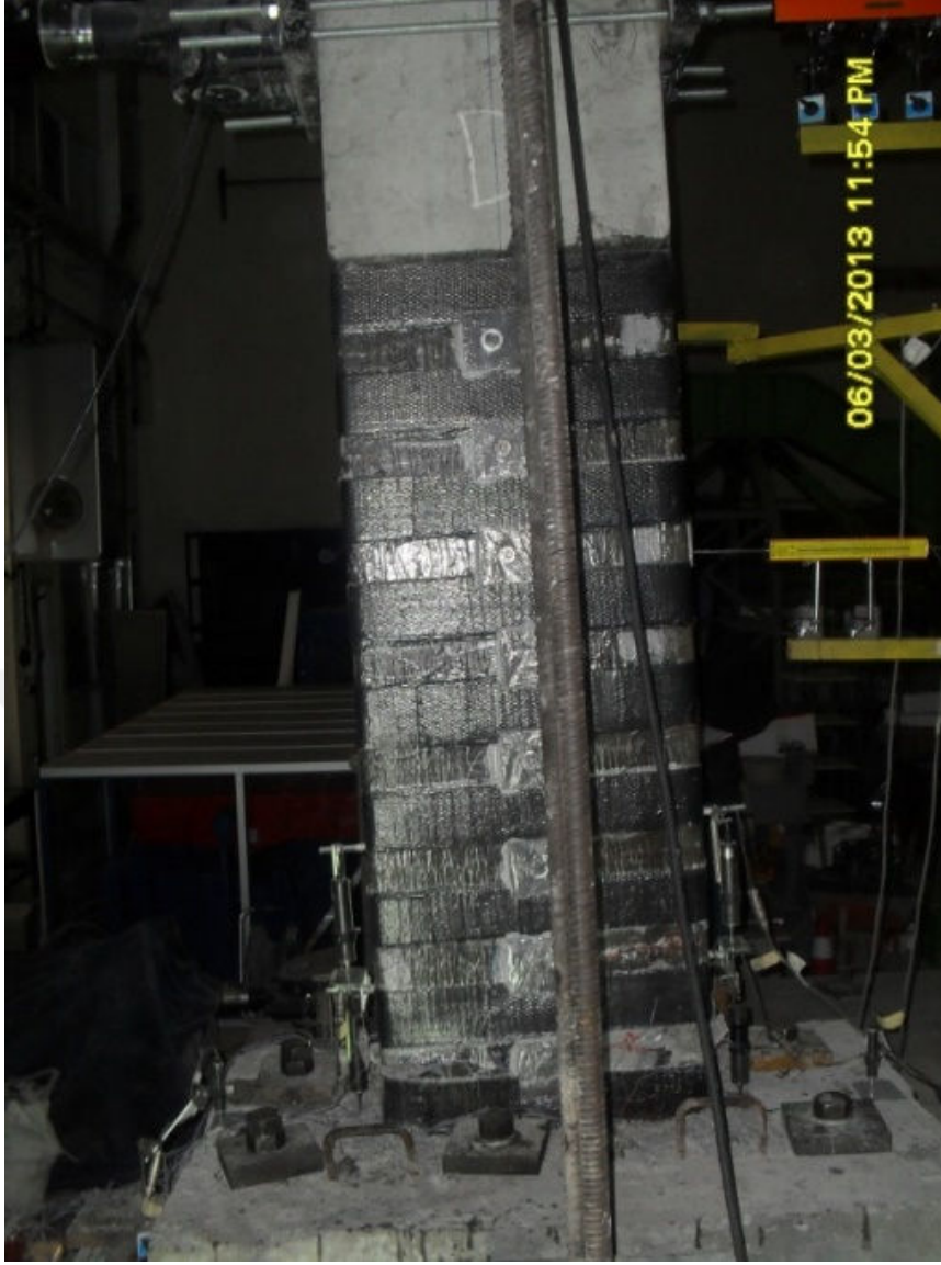
Şekil 4.43 : Yatay yük sıfır, kalıcı yer değiştirme 80.4 mm.
