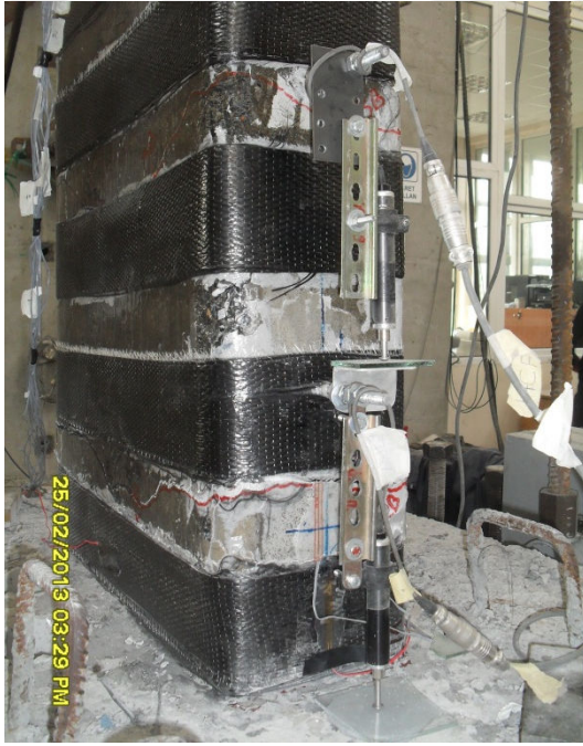
Şekil 4.20 : -0.03 görelî ötelemede çekme ve basınç bölgelerinde hasar durumu.
