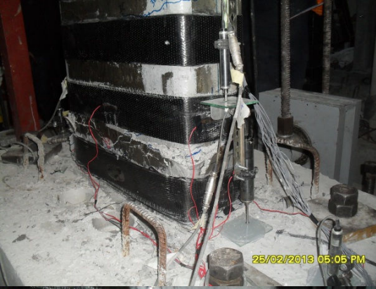
Şekil 4.25 : -0.04 görelî ötelemede çekme ve basınç bölgesinde hasar durumu.
