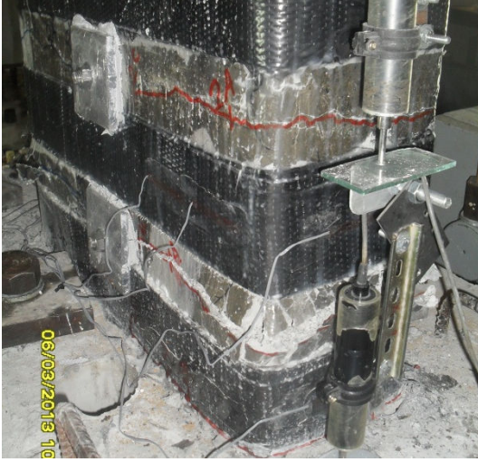
Şekil 4.37 : -0.05 görelî ötelemede çekme ve basınç bölgesinde hasar durumu.
