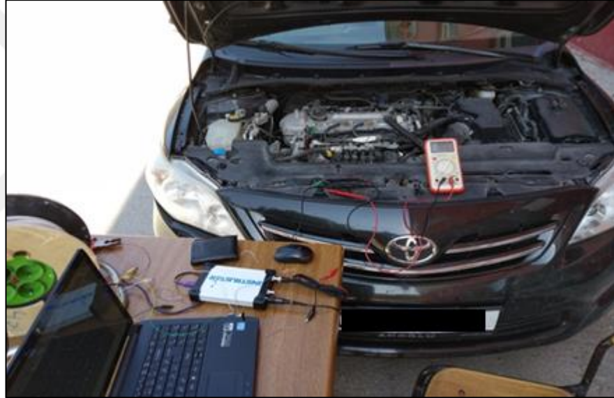
Şekil 31 Enjektör Ölçümlerinin Yapılması
