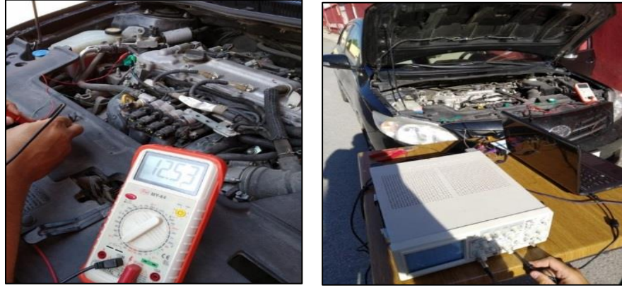
Şekil 30 Enjektörlere Gelen Sinyalin Tespiti
