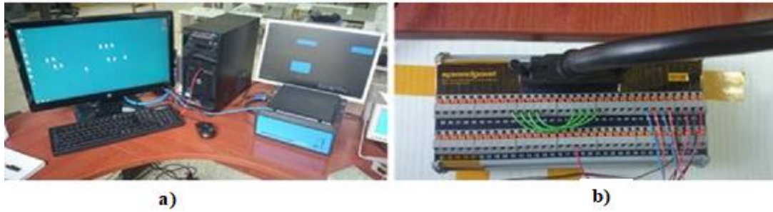
Şekil 3.9 : Veri toplama sistemi a) Ana bilgisayar ve hedef makine b) Terminal kartı (Akın, 2015).
