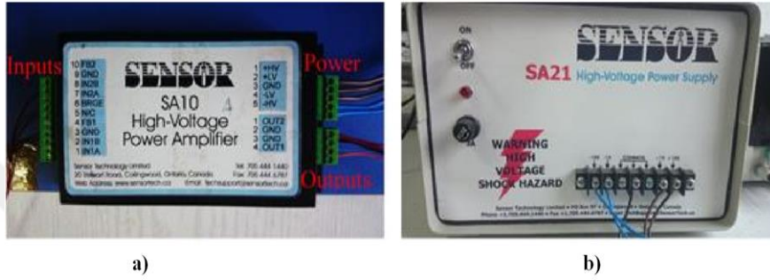
Şekil 3.11 : Amplifikasyon sistemi a) SA10 güç yükseltici b) SA21 güç kaynağı (Akın, 2015).
