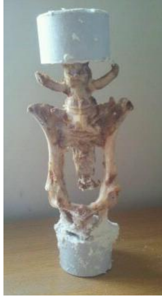
Resim 2. stten ve alttan har kalıbı ile tespit edilmiř materyal
