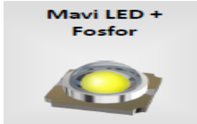
Şekil 1. 6. Mavi LED+Fosfor ile beyaz ışık eldesi.
