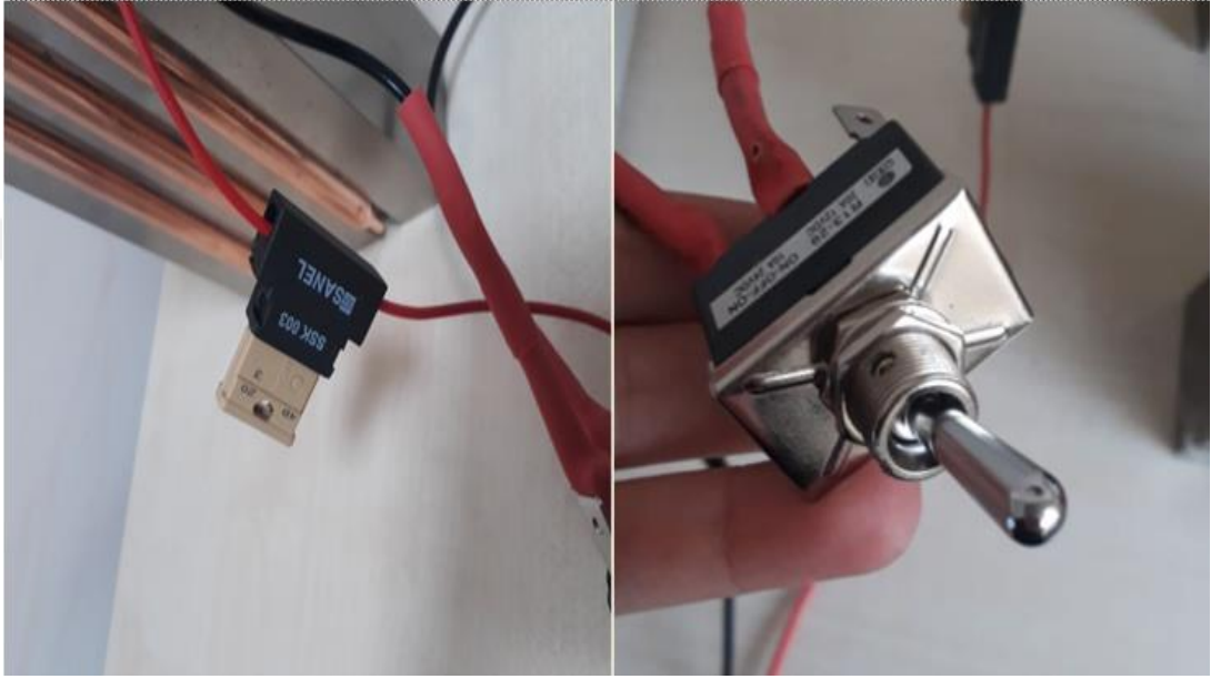
Şekil 3.13.a. Bıçak sigorta ve sigorta yuvası, b. On-off düğmesi.
