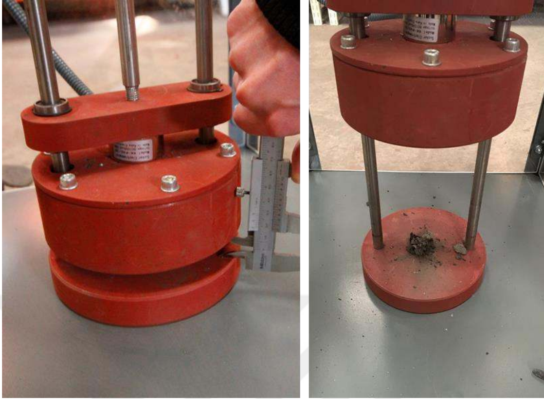
Şekil 35. Ağırlık düşürme testi kırılan parçacık
