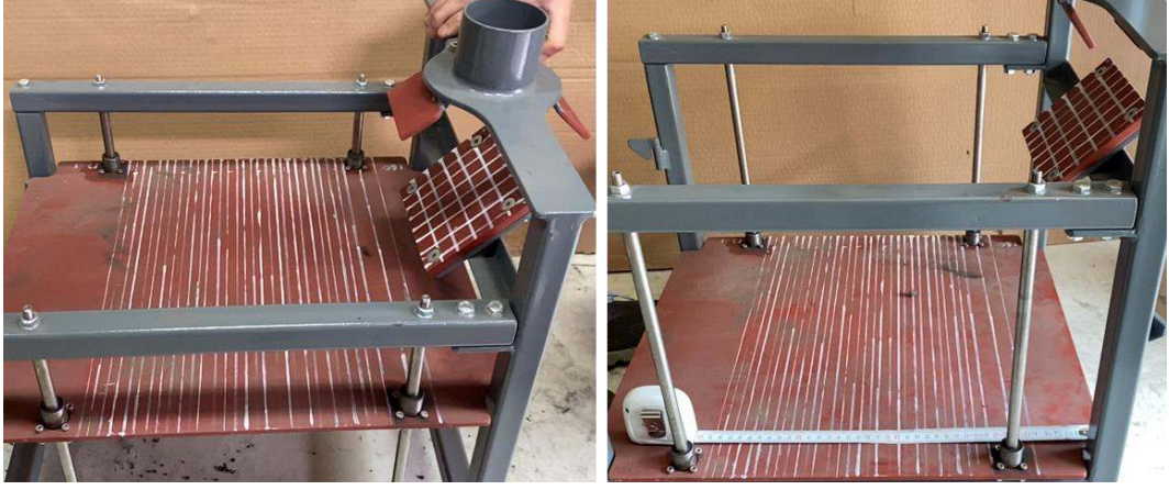
Şekil 26. St-37 plaka için geri sıçrama katsayısı testi
