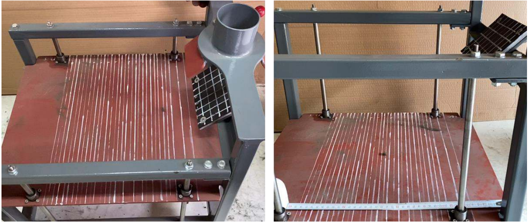
Şekil 28. Kauçuk için geri sıçrama katsayısı testi
