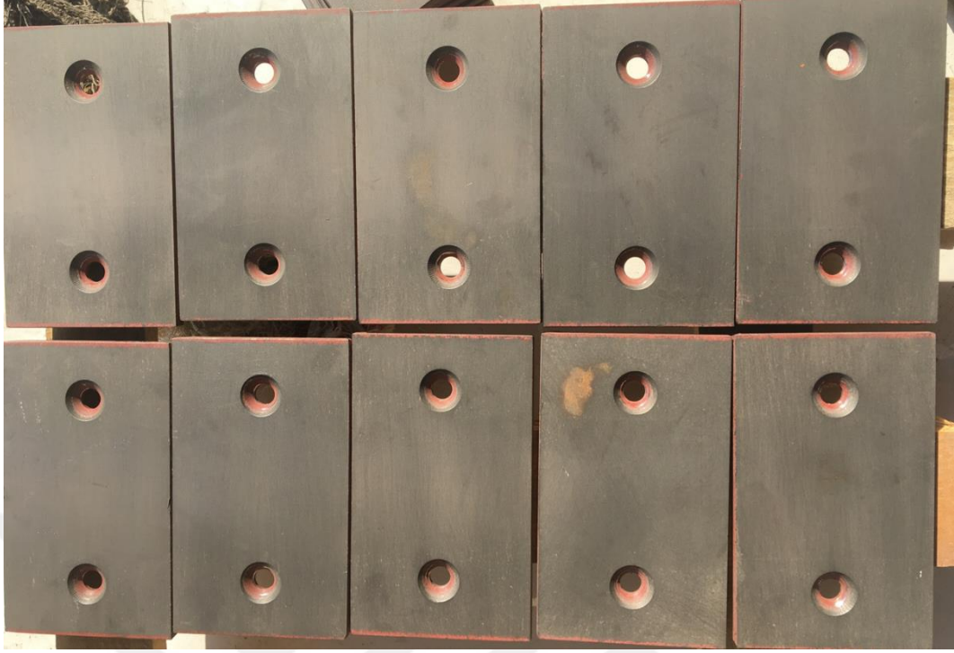
Şekil 39. Aşınma testi sonucu aşınan plakalar
