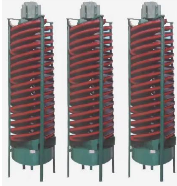
Şekil 6. Spiral ayırıcılar ile ayırma yönteminde kullanılan ekipmana (Alibaba, t.y.).
