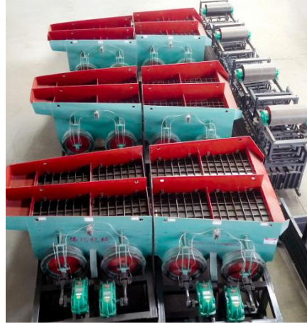
Şekil 4. Jig ayırma yönteminde kullanılan ekipman (Forui Mining, t.y.)
