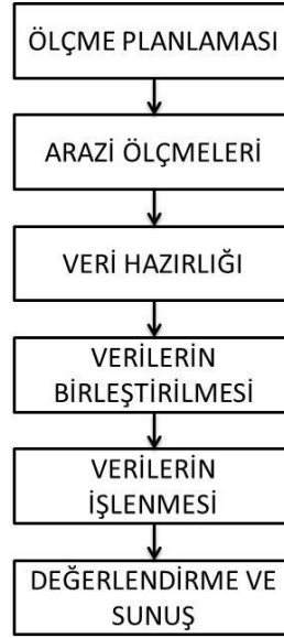
Şekil 4.70 G panosu güney şevlerinin yersel lazer ile izlenmesinde kullanılan işlem adımları
