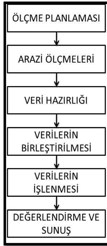
Şekil 4.40 Şev hareketlerinin yersel lazer tarama teknikleri ile izlenmesinde kullanılan işlem adımları
