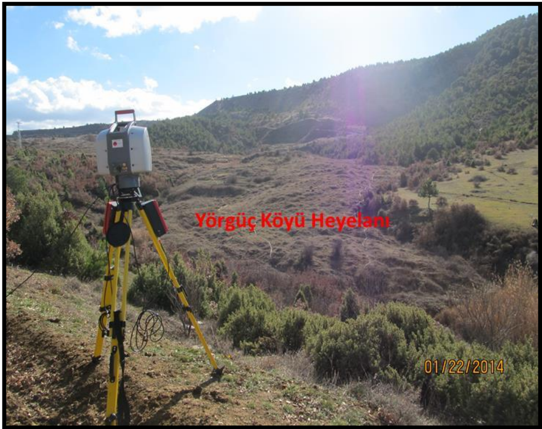
řekil 4.28 Yrg heyelanı izleme ynteminde kullanılan YLS tarama sistemi (Leica SS II)
