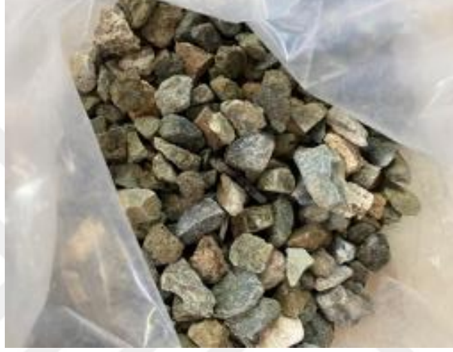
Şekil 12. Aşındırıcı malzeme olarak kullanılan doğal çakıl taşları
