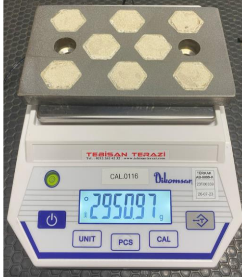
Şekil 20. Hassas terazi ile referans ve hibrit aşınma plakalarının test öncesi ağırlık ölçümü
