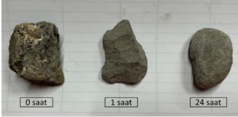
Şekil 32. Aşındırıcı malzemenin 0, 1 ve 24 saatlik test sonrası durumu
