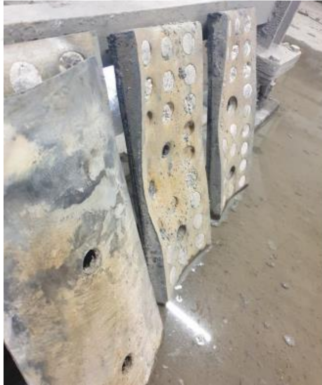
Şekil 37. Demir Export İspir işletmesinde SAG değirmen besleme şutuna montaj edilen Hardox 450 + alümina + neopren hibrit aşınma plakalarının 15. gün sonundaki durumu
