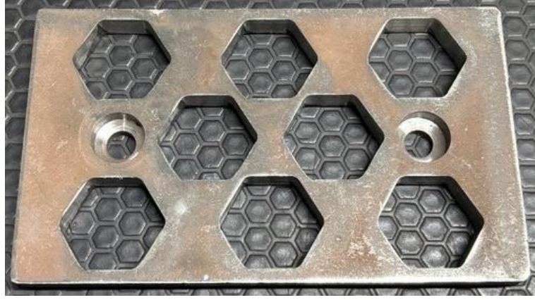
Şekil 6. Hardox 450 + alümina katkılı neopren ve Hardox 500 + alümina katkılı neopren hibrit aşınma plakalarını oluşturan metal matris
