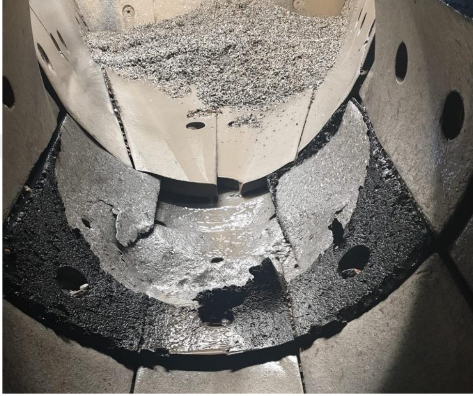
Şekil 23. Demir Export İspir işletmesinde bulunan SAG değirmen içerisine bakır – çinko cevheri besleme şutu aşınma durumu
