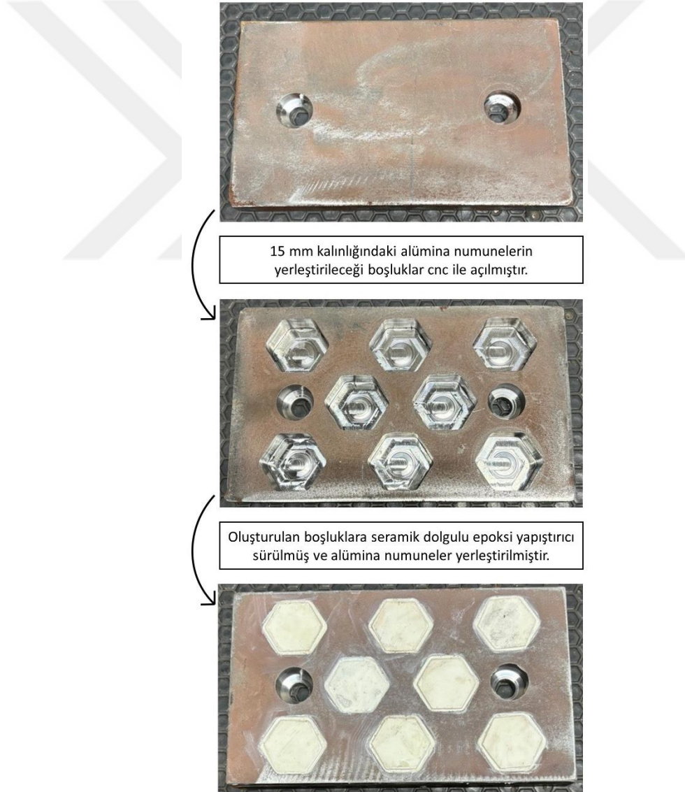
Şekil 15. Hardox 450 + alümina ve Hardox 500 + alümina aşınma plakalarının imalat aşamaları
