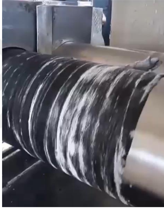
Şekil 9. Kauçuk hamur makinesi ile alümina tozlarının kauçuk hamuruna eklenmesi
