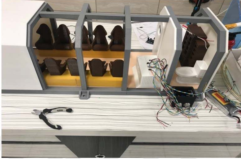
Şekil 6.27. Elektronik aksamaların yerleştirilmesi.
