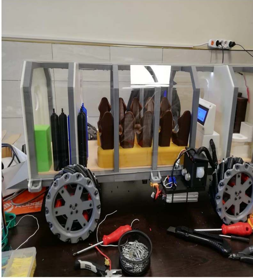
řekil 6.28. Tařınabilir sığınma odası sisteminin tekerleklerinin montajı.
