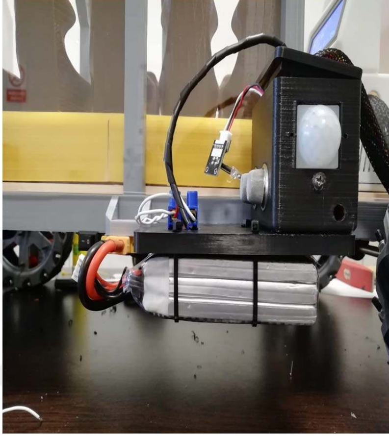
řekil 6.29. Sıgınma odası sisteminin güç kaynağının yerleştirilmesi.
