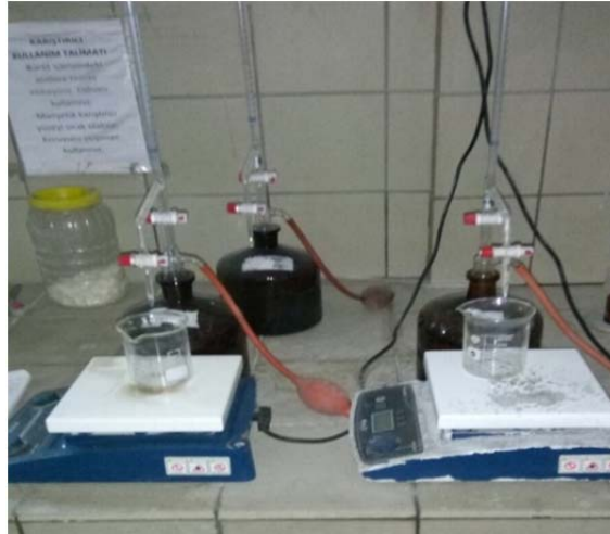
Şekil 4.5. Aktif kalsiyum oksit deneyi
