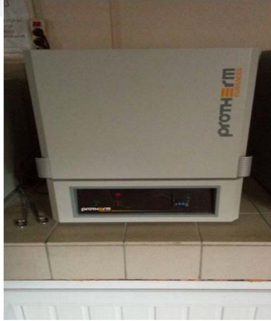
Şekil 4.4. Kamara tipi yüksek sıcaklık fırını
