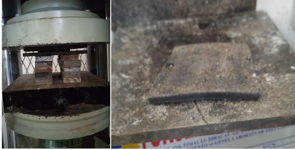
Şekil 4.5. Sürtünme pedlerinin yük altında davranışı
