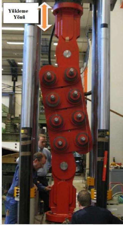
Şekil 1. 23. Daptech firması tarafından üretilen 500 ton kapasiteli sönümleyici [9]
